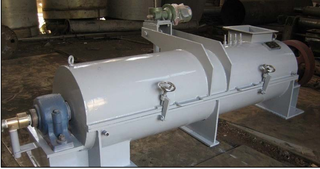
Şekil 13: Tutkallama makinası genel görünüşü (URL-15, 2015).
