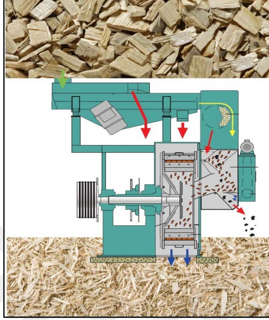
Şekil 8: Chipsin yonga haline getirilmesi (URL-9, 2015).
