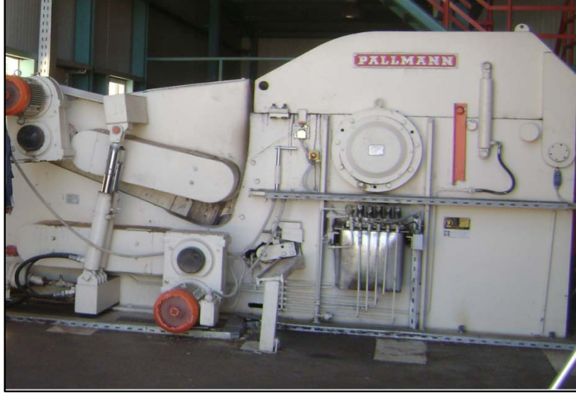
Şekil 19: Chipper kaba yongalama makinası.
