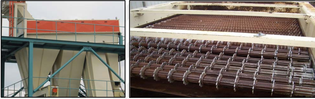
a. Diskli elek dış görünüşü. b. Diskli elek iç görünüşü.
