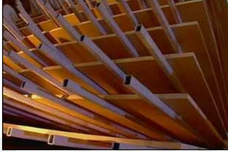
Şekil 41: Yıldız soğutucu (Fotoğraf: Ekrem ÇAKMAK, 2008).
