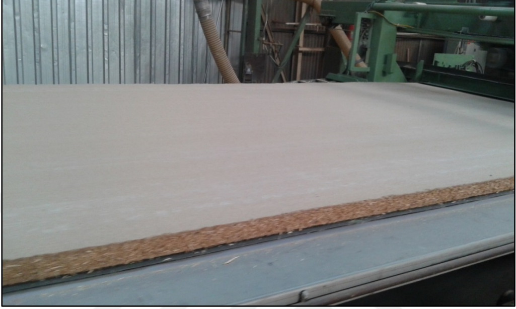
Şekil 37: Ön pres çıkışı levha taslak görünümü.
