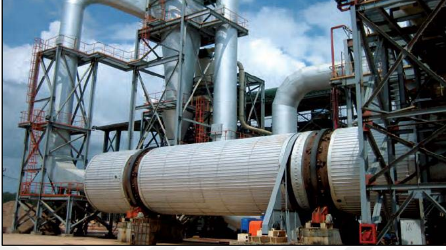
Şekil 9: Döner silindirli kurutma makinası genel görünüşü (URL-10, 2015).
