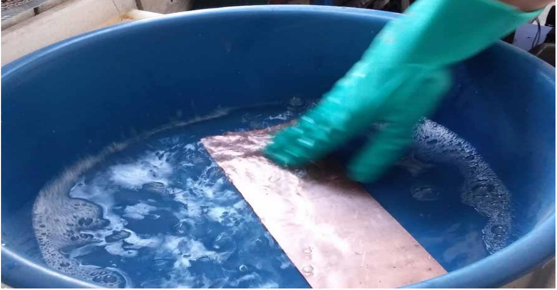
Şekil 3.17. Bakır levhanın temizlenmesi
