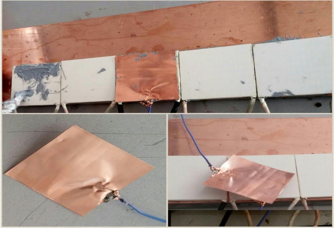
Şekil 3.23. K tipi direkt temaslı sıcaklık probu.
