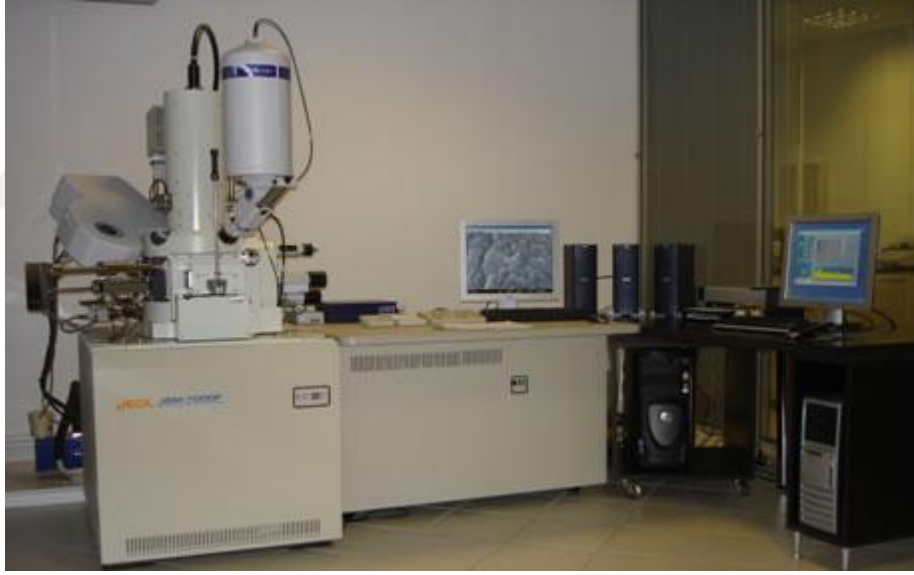
Şekil 5.4: JEOL JSM 7000F marka alan emisyonlu tarama elektron mikroskobu.
