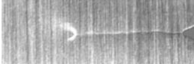
Şekil 3.8. Çatlak ucu dallanması (crack branching).
