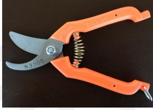
Şekil 1.7 Turunçgillerin toplanmasında kullanılan hasat makası (Anonim 2016a)
