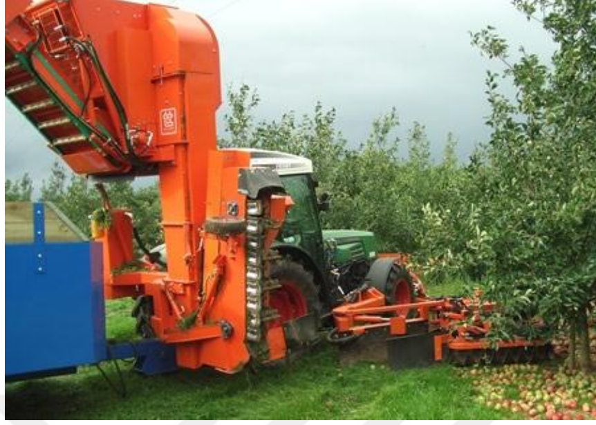
Şekil 1.23 Elma hasadında kullanılan toplayıcı makina (Anonim 2012h)
