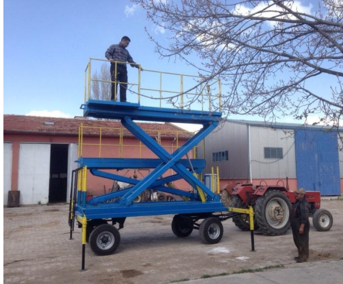
Őekil 4.2 Meyve hasat platformunun makas kolları ve destek ayakları açık görünüşü
