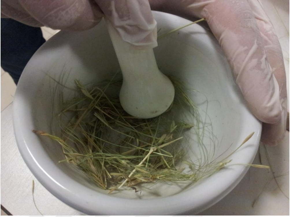
Şekil 4.3. Numunelerin havanda öğütülmesi.
