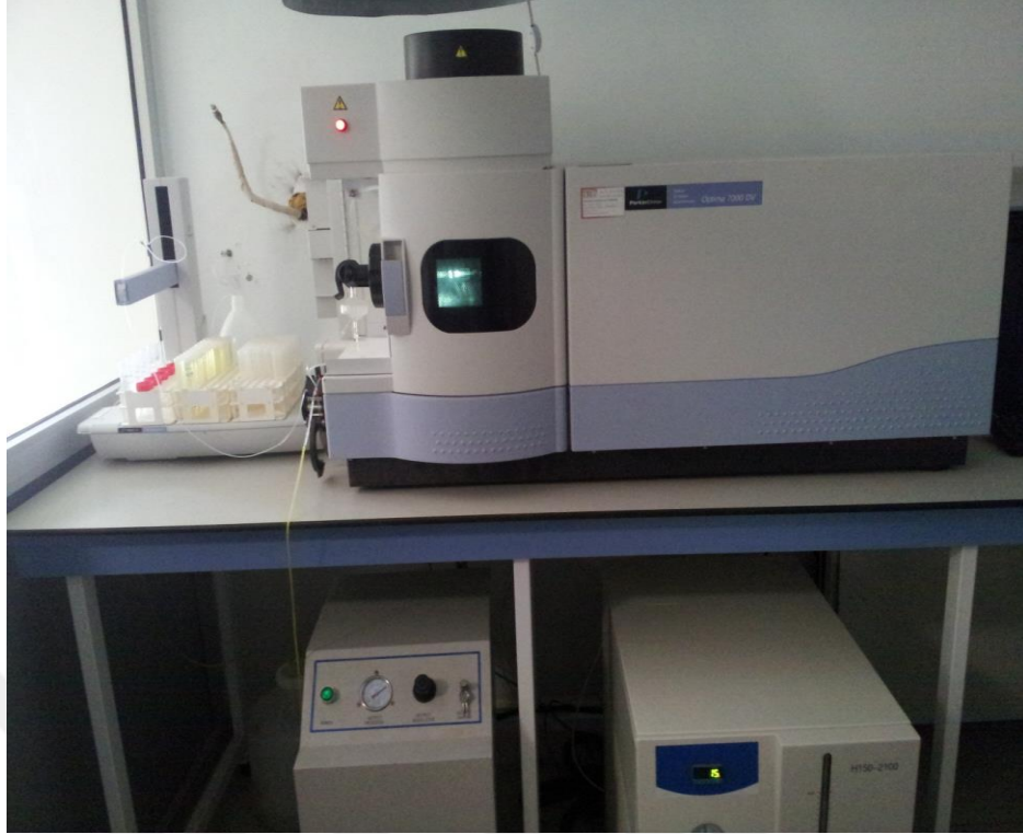
Şekil 4.11. ICP (Inductively Coupled Plasma) cihazı.
