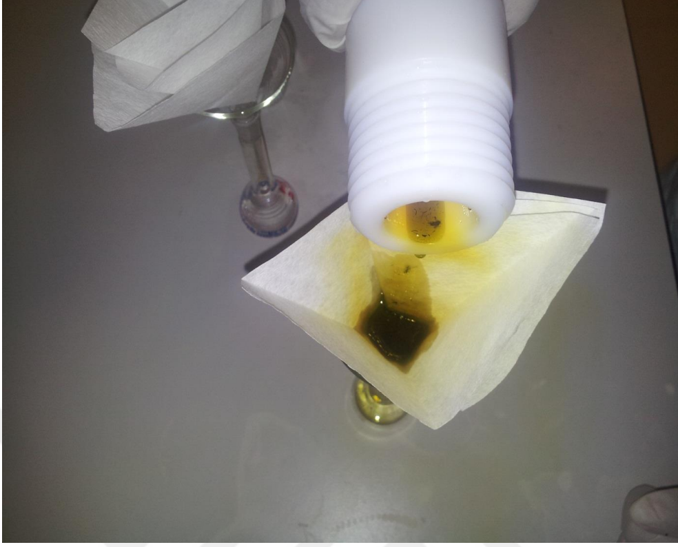
Şekil 4.7. Numunelerin 50 ml'lik hunilere bırakılması.
