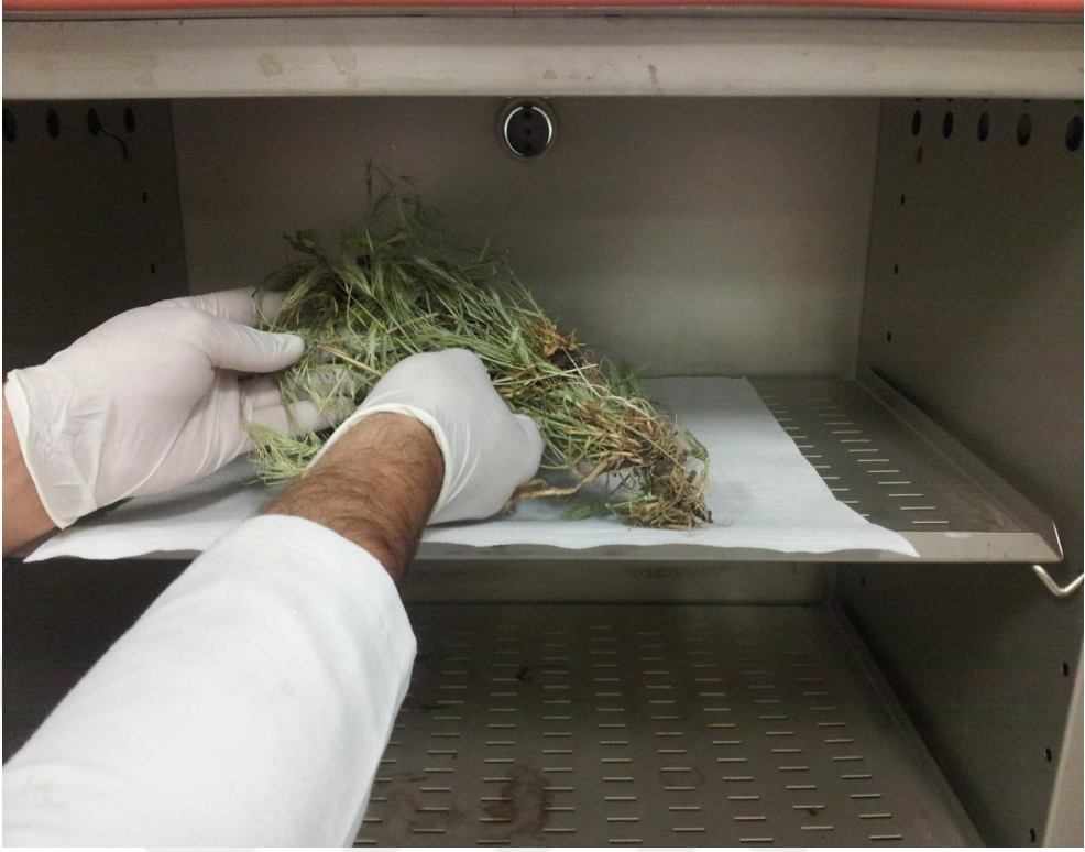
Şekil 4.5. Numunelerin micro dalgada yakılması.
