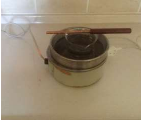
Şekil 14. Bakır çubuk (100 °C'de ısıtılarak kullanıldı)
