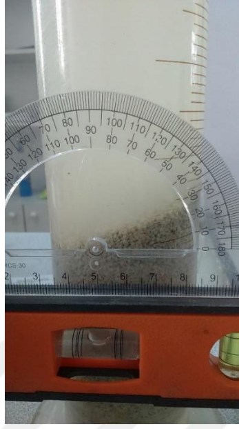
Şekil 3.20. Malzemenin yığılma açısının okunması (1,18 mm ile 1,40 mm arası tane çapına sahip malzeme)
