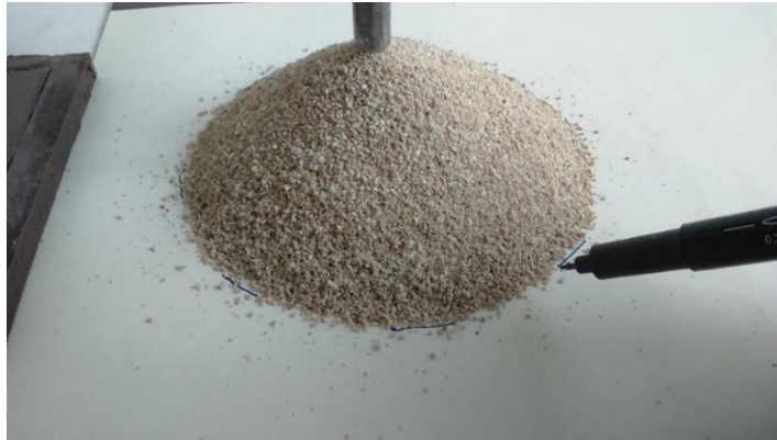
Şekil 3.9. ASTM C1444'de göre kum üzerinde yığılma açısını belirlemek için yapılan deney
