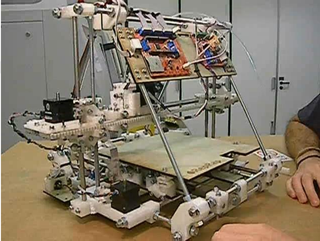
Görsel 15. RepRap topluluğu tarafından üretilen 2.0 (Mendel) isimli 3B yazıcı modeli
