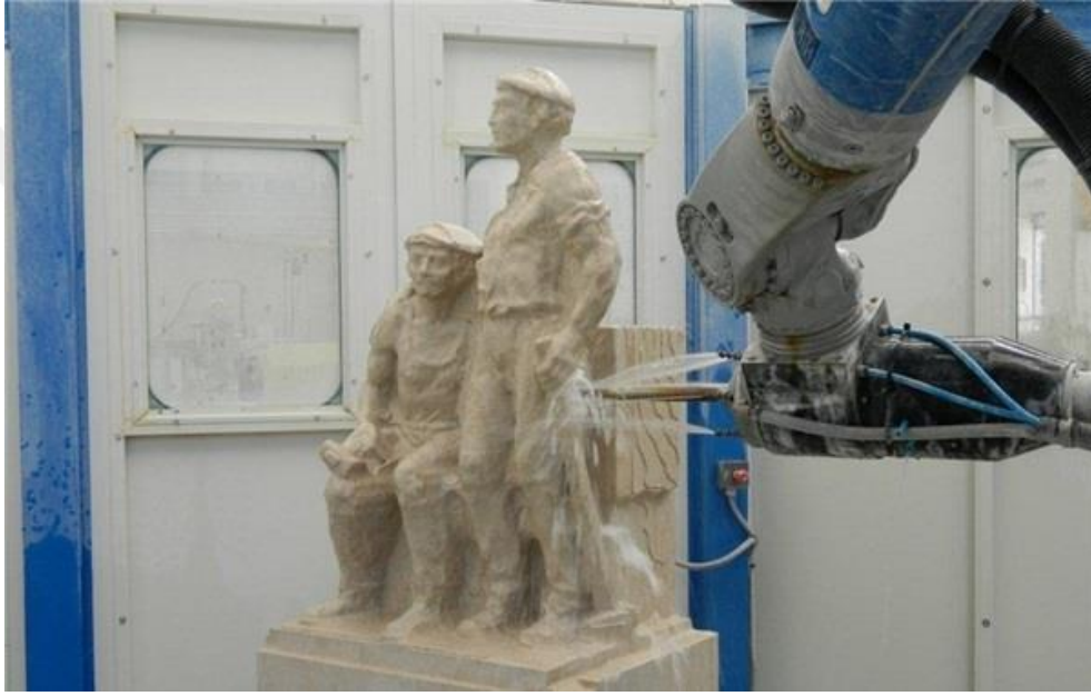
Görsel 12. TD Robotics firmasının atölyelerinde CNC makine ile taş işlenmesi
