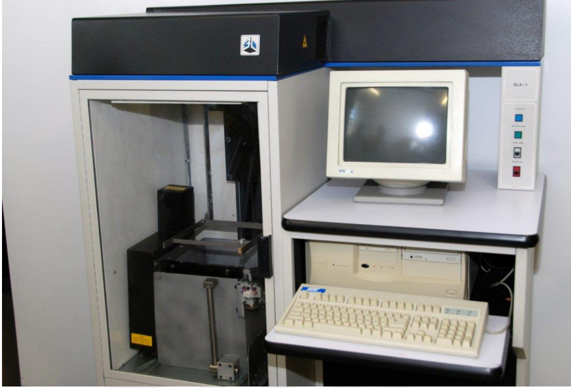
Görsel 14. SLA-1 isimli ilk Stereolitografi yöntemiyle çalışan 3B yazıcı
