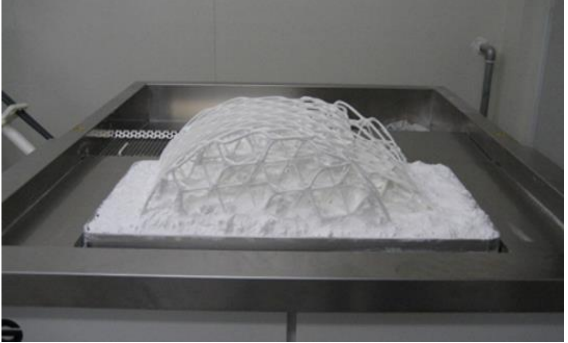
Görsel 18. SLS baskı sonrasında çıktının tozlardan arındırılması
