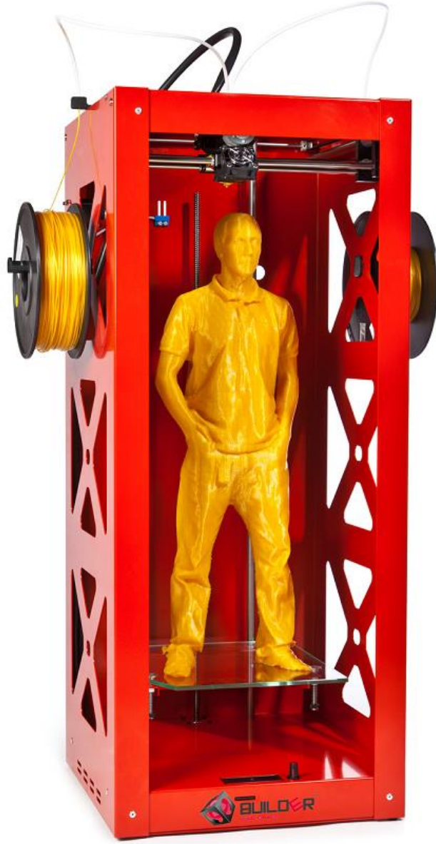
Görsel 19. FDM tekniğiyle baskı yapan bir 3B yazıcı ve içinde çıktı obje
