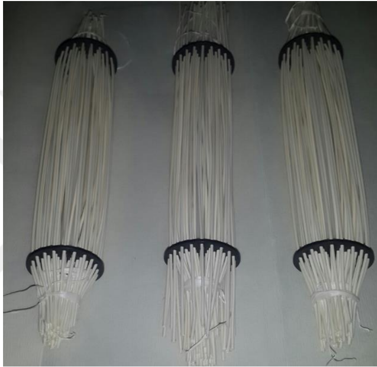
Şekil 3.16 : Boşluklu fiber (hollow fiber) membranların dizilimleri.
