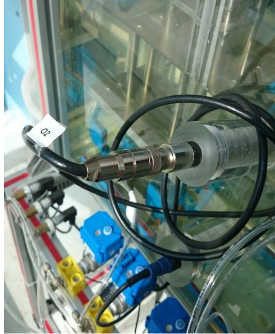
Şekil 3.3 : Çözünmüş oksijen probunun görünümü.
