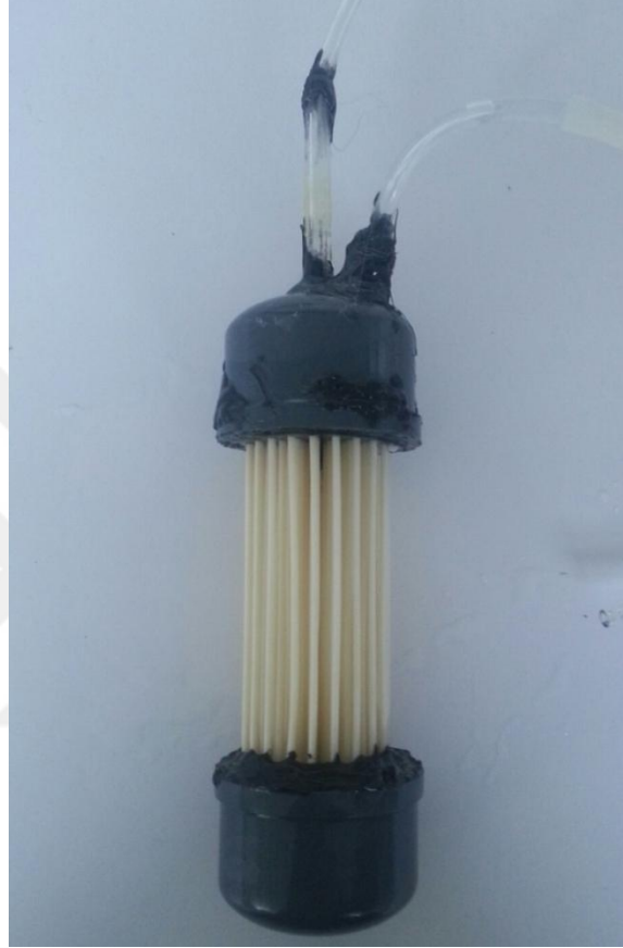
Şekil 3.17 : Bağlantıları yapılmış kullanıma hazır laboratuvar ölçekli MBR modülü.
