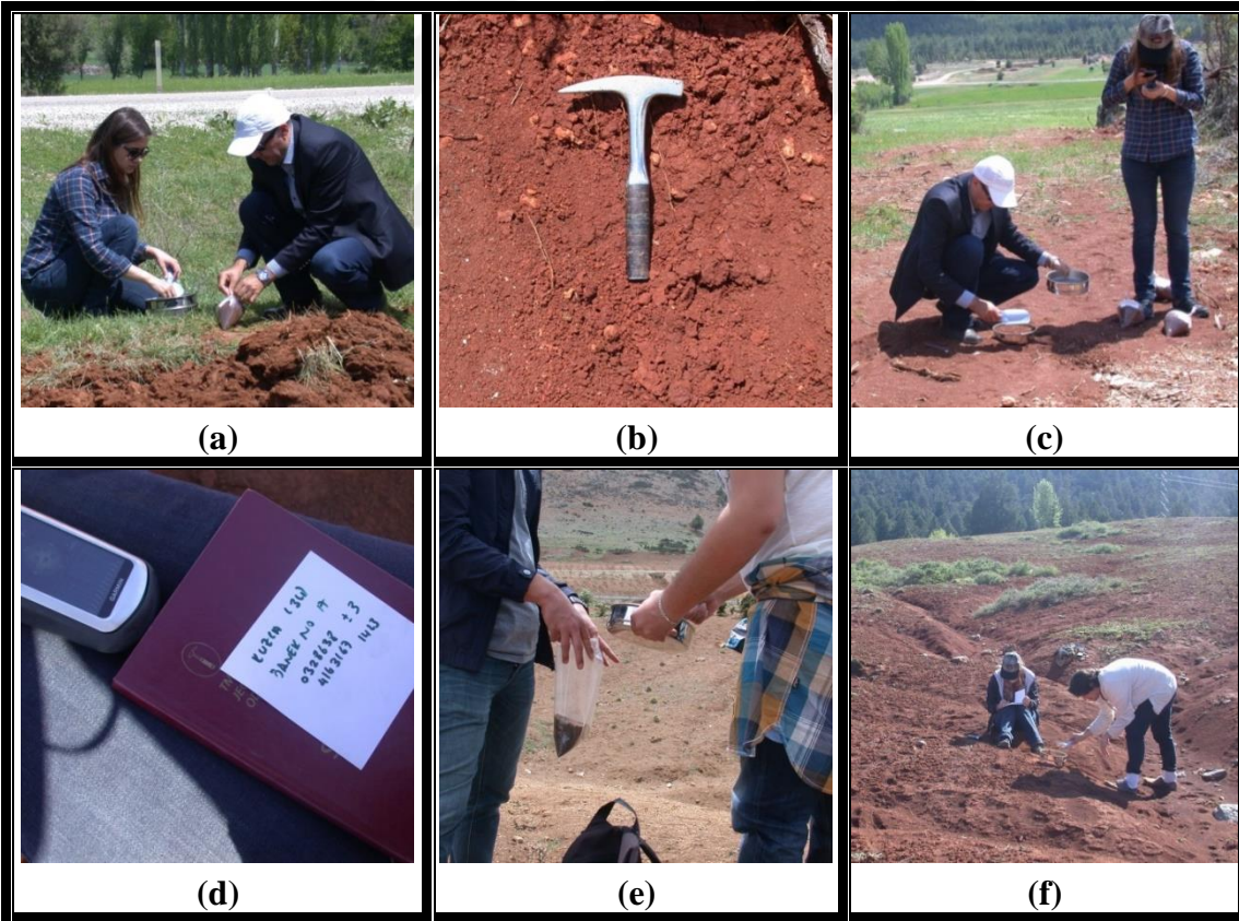
Şekil 3.1. Arazi çalışmaları: (a,b) çalışma alanından örnek alma işlemi, (c,d) GPS cihazı ile koordinat belirleme ve numune kartlarının hazırlanması, (e) örneklerin plastik torbalara konulması, (f) arazi ve numune bilgilerinin kaydedilmesi.
