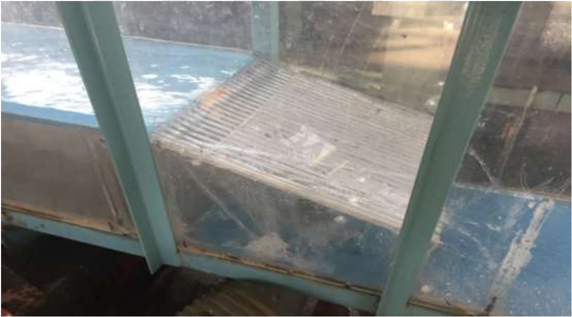
Şekil 4.2. Izgaraların plaka ile kapatılarak ızgara boyunun değiştirilmesi
