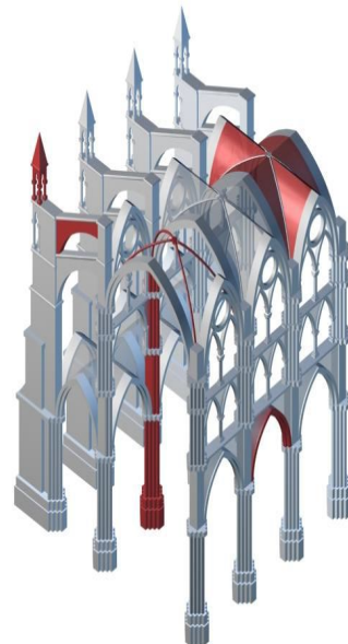
Şekil 4.10b. Uçan payandalar için konstrüksiyon fikri (Hussein, 2011).
