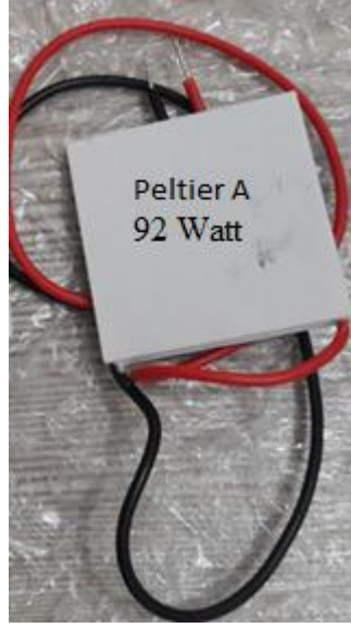
Şekil 3.5: Deney düzeneğinde kullanılan termoelektrik modül Peltier A.
