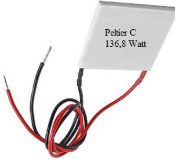
Şekil 3.7: Deney düzeneğinde kullanılan termoelektrik modül Peltier C.
