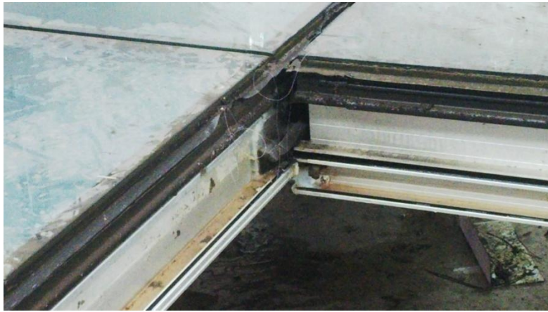
Şekil B.10 : (a) Numune transfer işlemi, (b), (c) Panel söküm işlemi, (d), (e) Panel birleşim noktasında oluşan hasar durumu.
