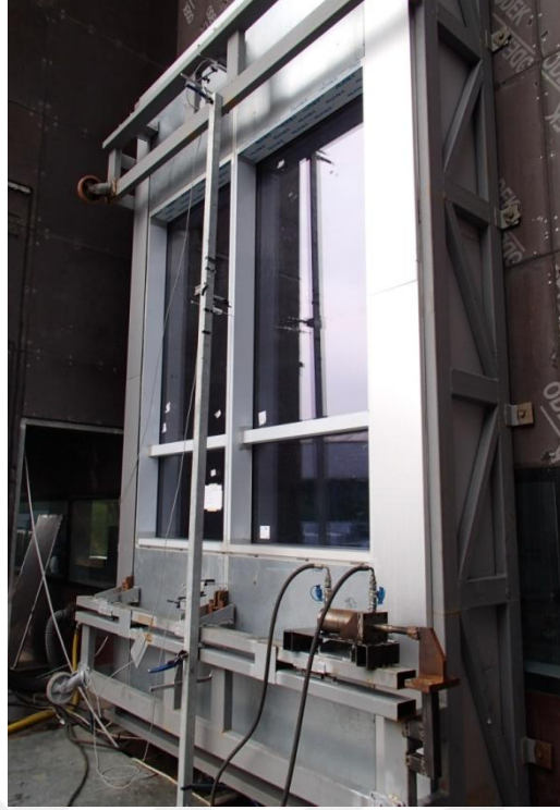
Şekil 3.44 : Sismik dayanım deneyi esnasında deney numunesi.
