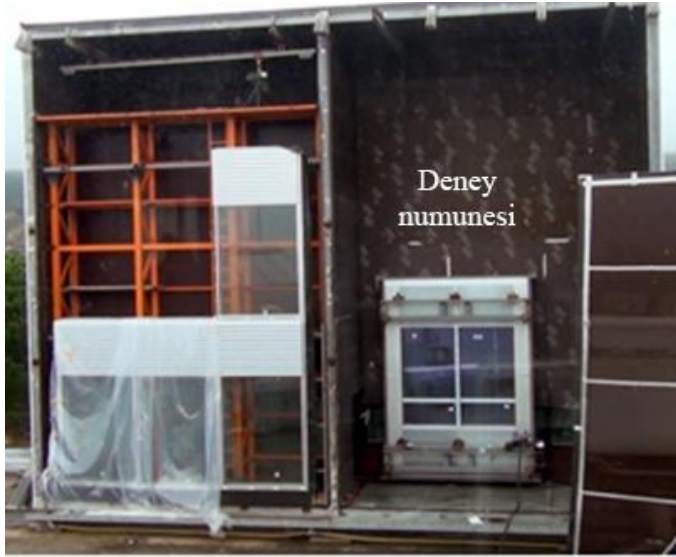
Şekil 3.4 : Deney düzeneğine yerleştirilmiş cephe numunesi.
