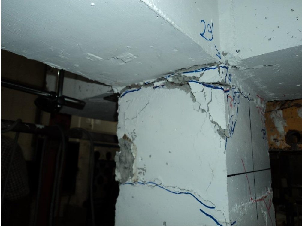
Şekil 6.7: Kolon elemanlarda parçalanmalar.
