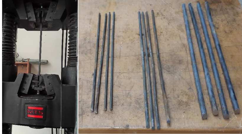
Şekil 5.4: Çelik çekme deney düzeneği ve deney numuneleri.
