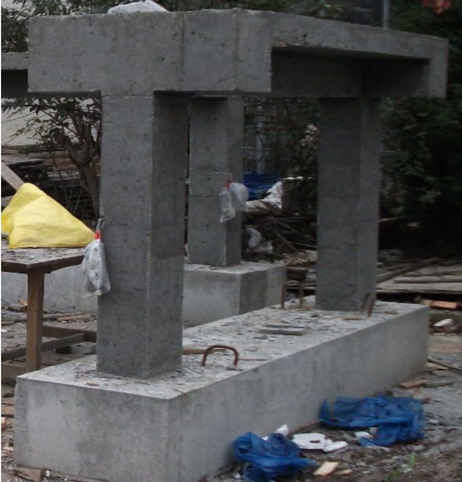
Şekil 1.3 : Çalışmalarda kullanılan betonarme çerçeve.
