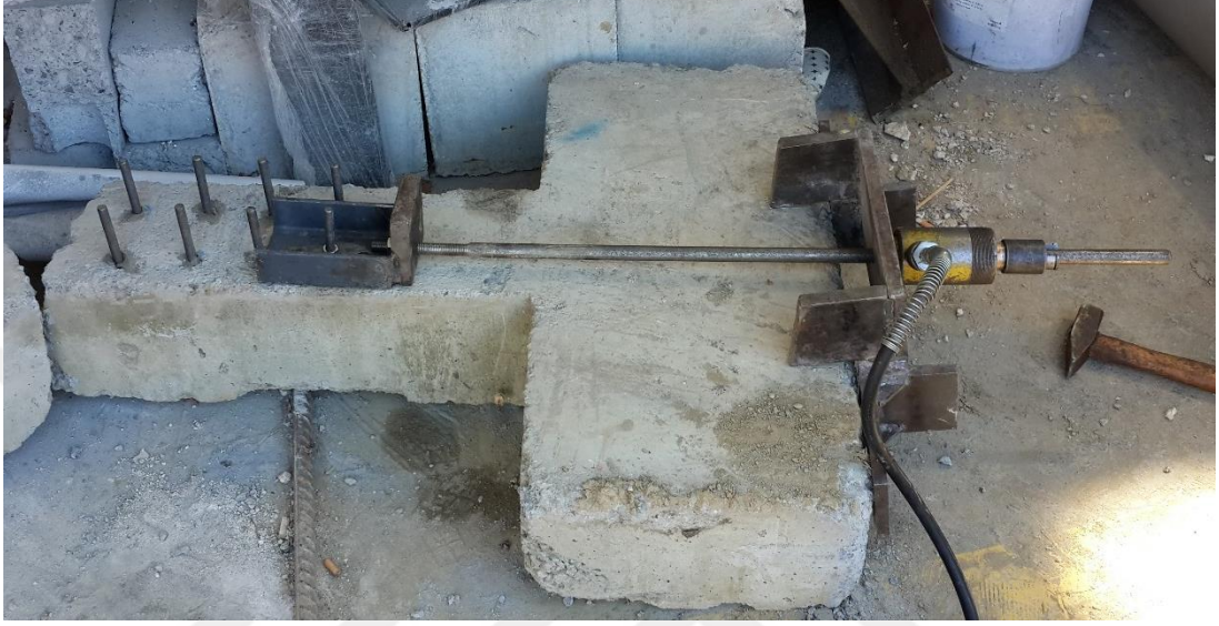
Şekil 5.12: Ankraj bulonu kayma testi deney düzeneği.
