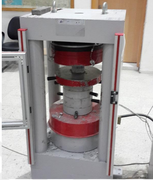
Şekil 5.8: Beton kırımı deney düzeneği.
