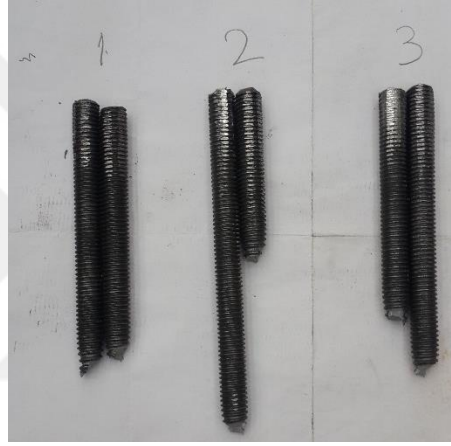
Şekil 5.14: Ankraj bulonlarının çekme testi sonrası deformasyonları.
