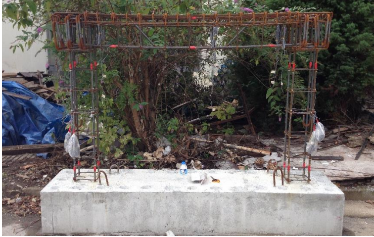
Şekil 3.2 : Numune donatı düzeni ve gerinim pullarının yerleşimi.
