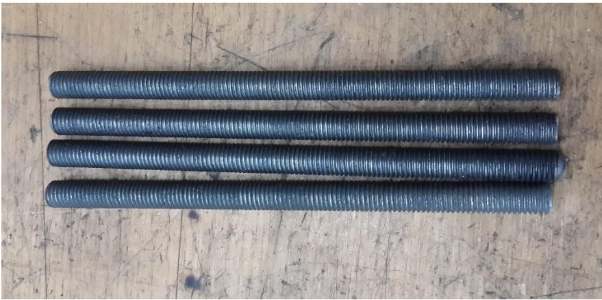
Şekil 5.11: Ankraj bulonu çekme testi numuneleri.
