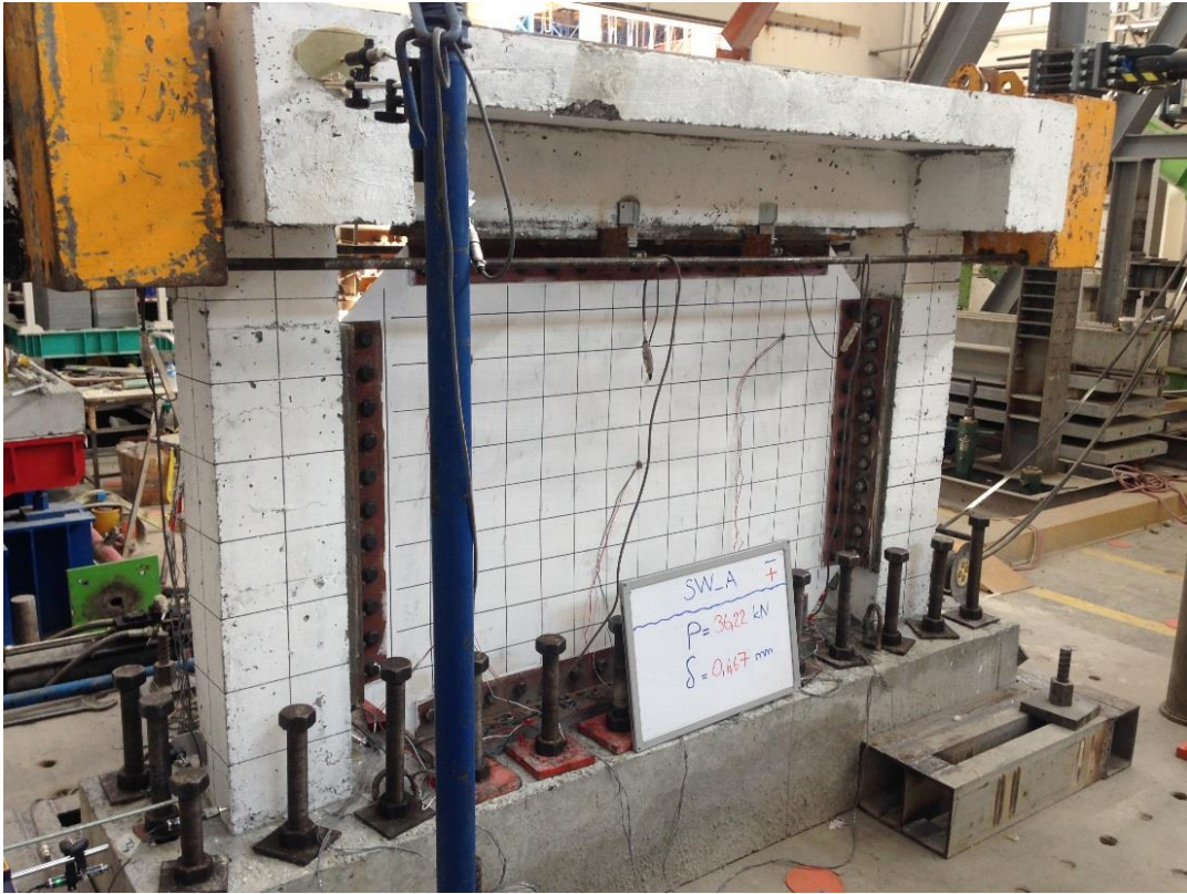
Şekil 3.7 : Montajı tamamlanarak deney düzeneğine yerleştirilmiş numune.
