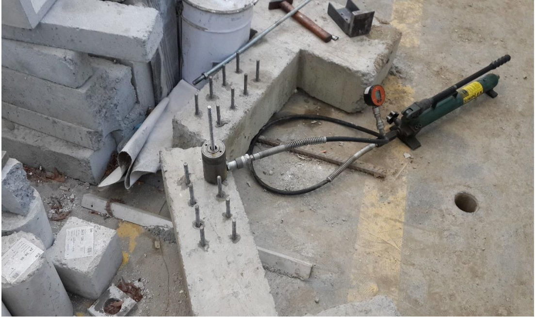
Şekil 5.13: Ankraj bulonu çekme testi deney düzeneği.
