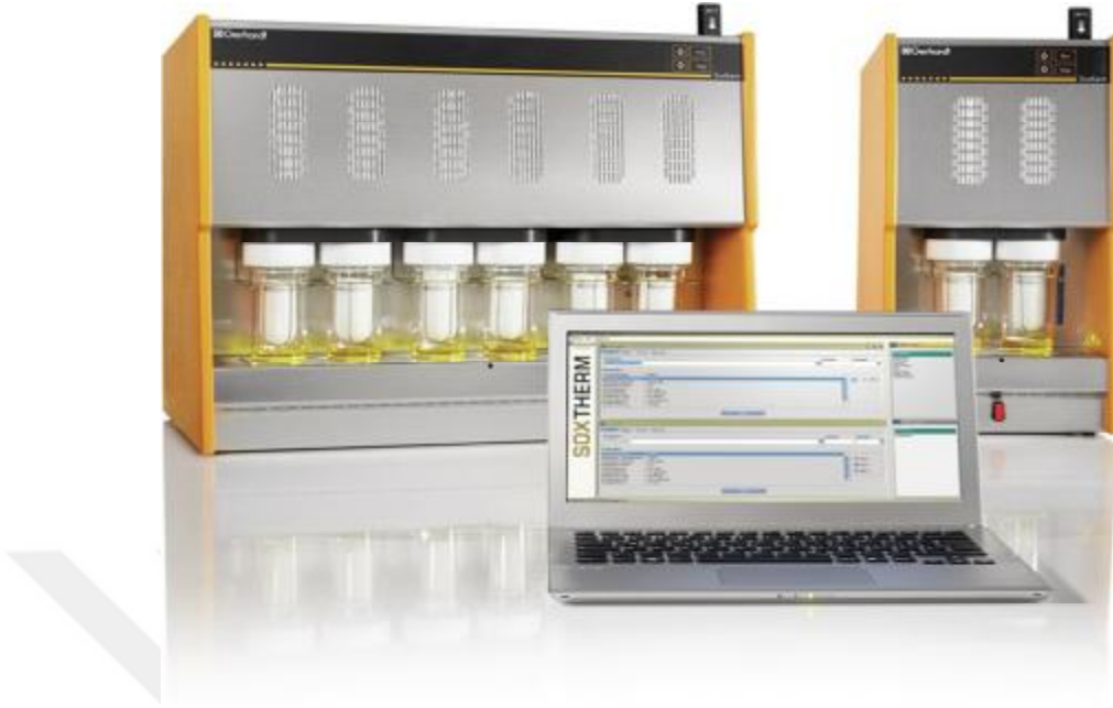
Şekil 3.15. Otomatik Soxhalet cihazında ceviz yağlarının elde edilmesinden genel bir görünüm.
