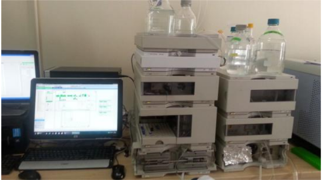
Şekil 3.20. Tokoferol analizlerinin yapıldığı HPLC Cihazından bir görünüm.
