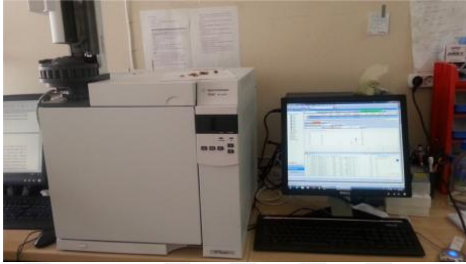
Şekil 3.17. Yağ asidi analizi yapılan GC/FID cihazından genel görünüm.
