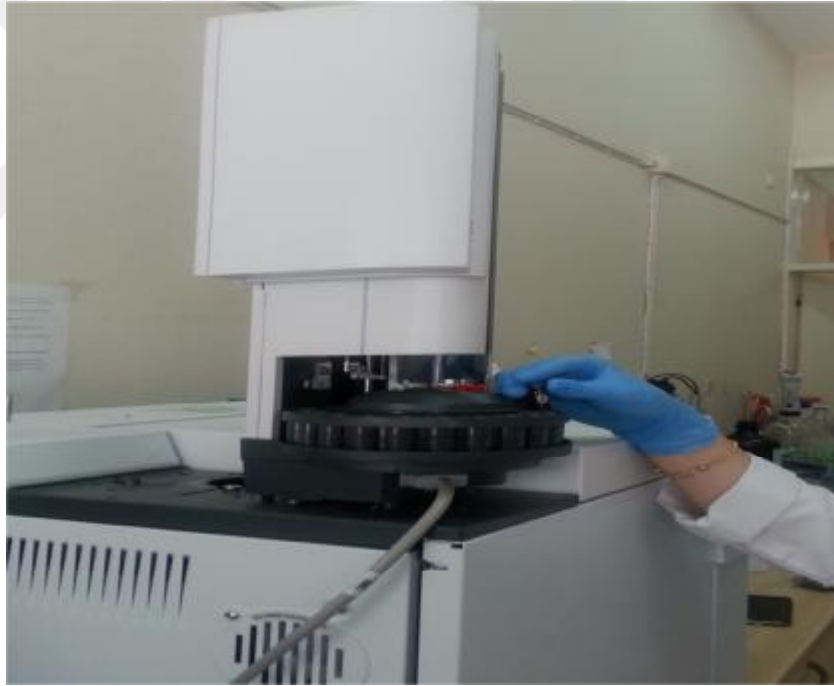
Şekil 3.18. Yağ asidi analizlerinin yapıldığı GC cihazı ve örneklerin yüklenmesi aşamasından bir görünüm
