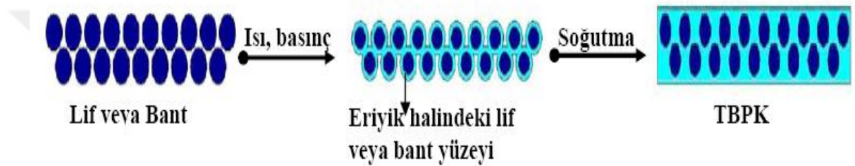
Şekil 3. Sıcak sıkıştırma yönteminin şematik gösterimi [5].
