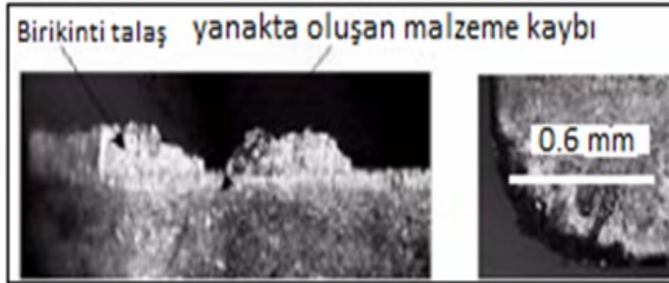
Şekil 9.16: Birikinti Talaş ve Yanak Aşınması
