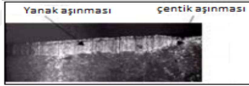
Şekil 9.15: Çentik ve Yanak Aşınması
