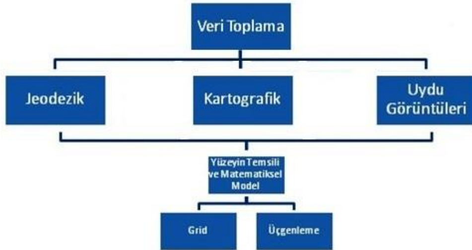
Şekil 3.6. Sayısal Yükseklik Modelleri Üretimi / Oluşturmak için Akış Diyagramı (Saygılı, 2004).
