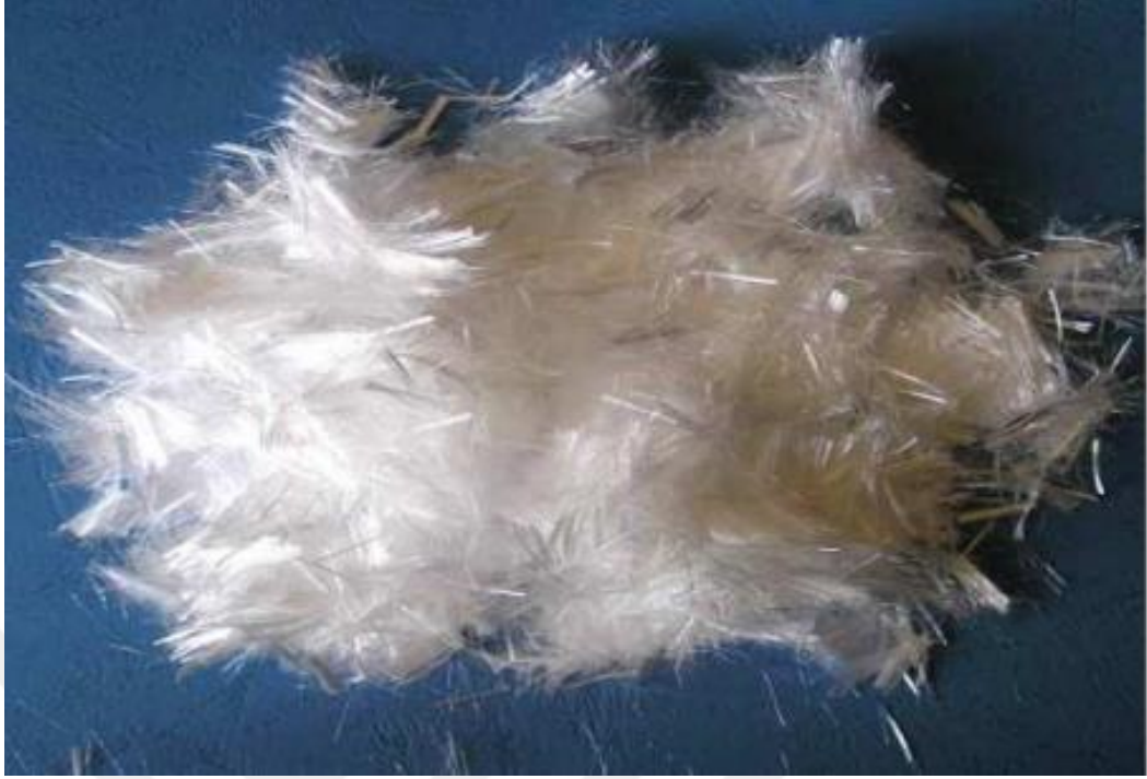
Şekil 1.5 Polimer esaslı lif (Polipropilen) (Kanalli, Palankar, B. Kumar, P. Kumar ve Parakash, 2014).
