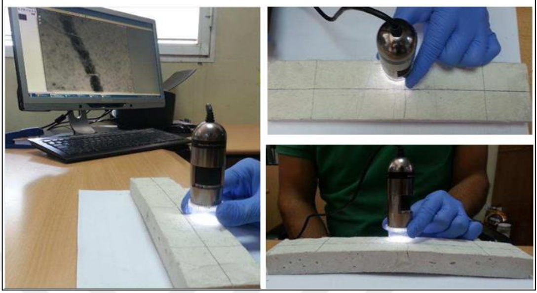
Şekil 2.5 Çatlak analizi yönteminde kullanılan portatif el mikroskobu ve numune üzerinde yapılan işlemler.
