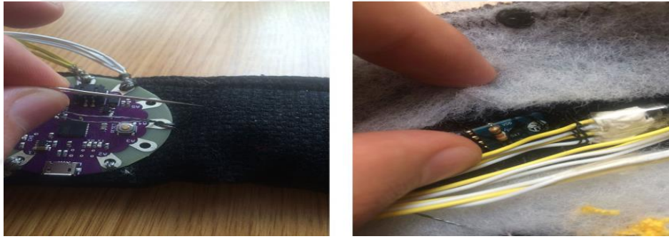
Şekil 3.17. Senörlerin ve ana kartın kumaş üzerine dikilmesi
