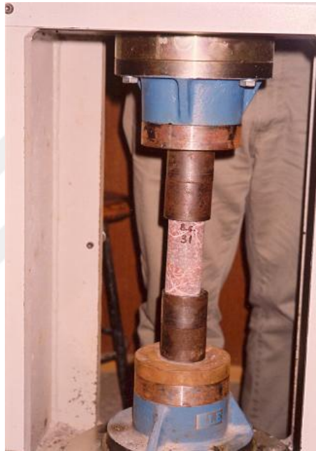
Şekil 3.1 Tek eksenli basınç deneyinin yapılışı
