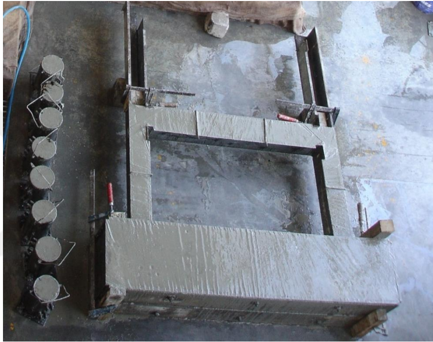
Şekil 3.2. Deney elemanı beton dökümü ve silindir numuneler
