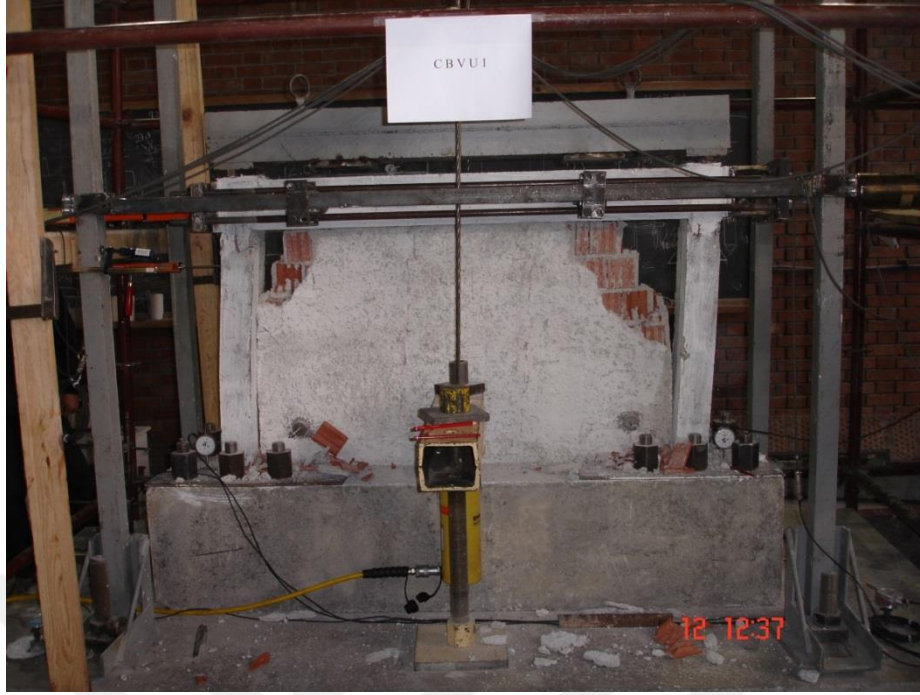
Şekil 3.15. Deney sonucunda deney elemanında gözlenen hasar
