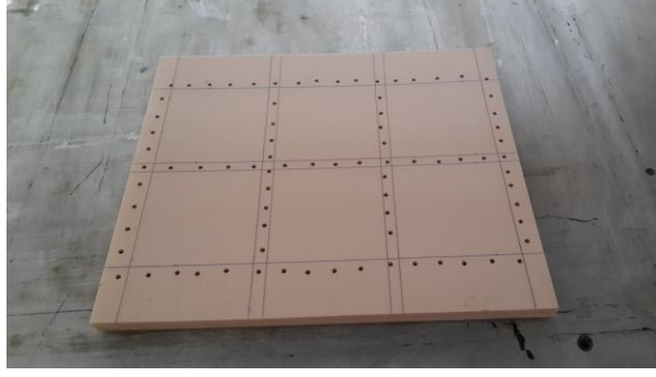
Şekil 3.7. Köpük malzemenin delinmesi
