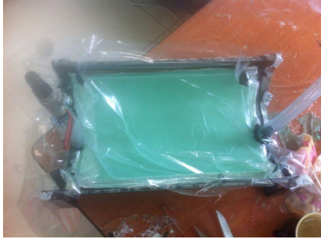
Şekil 3.20. Vakum ortamına alınmış kalıp
