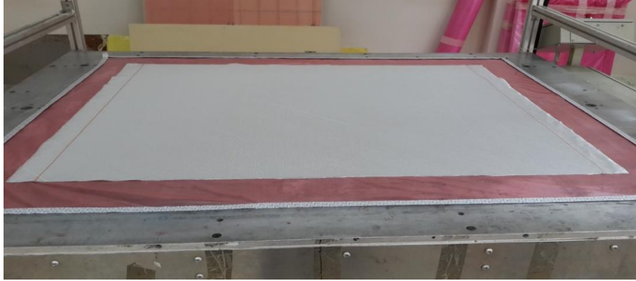
Şekil 3.21. Düz plakaların üretiminde kumaş yerleşimi
