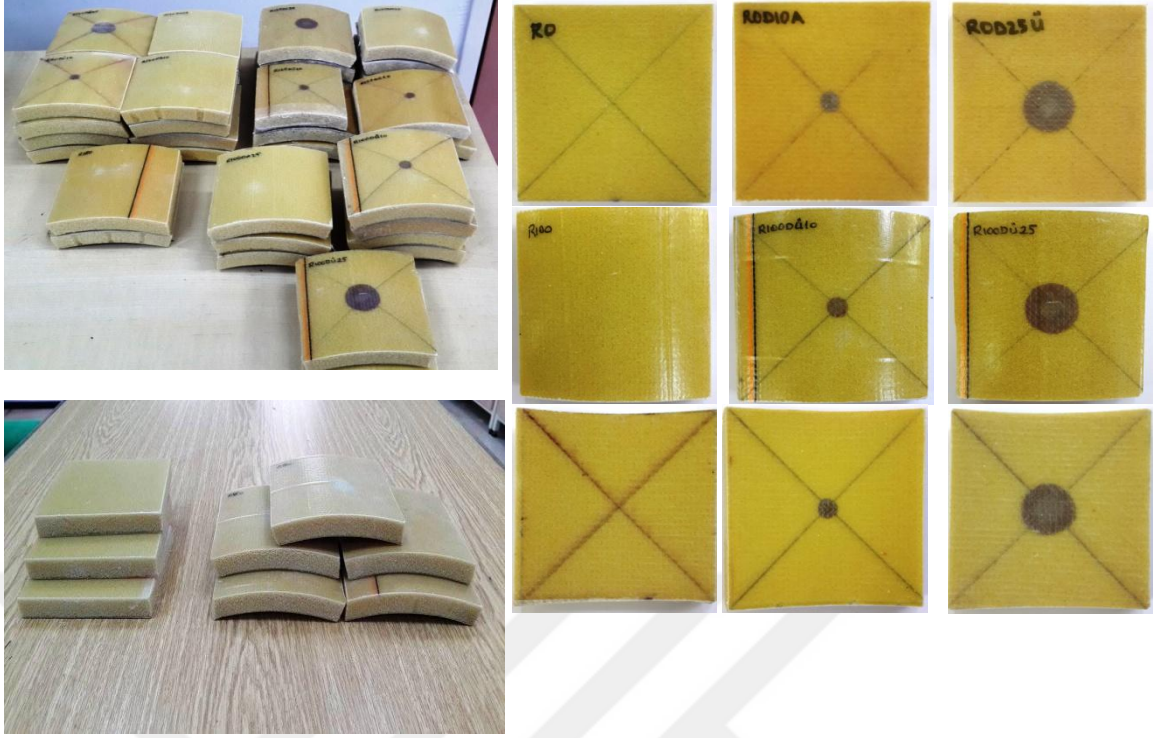
Şekil 3.26. Darbe ve titreşim testleri için hazırlanmış numuneler
