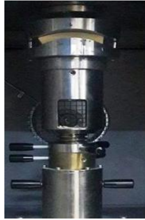
Şekil 3.30. Eğri tutucunun ve numunenin test cihazındaki yerleşimi
