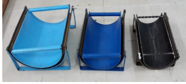
Şekil 3.2. Sandviç panellerin üretimde kullanılan kalıplar
