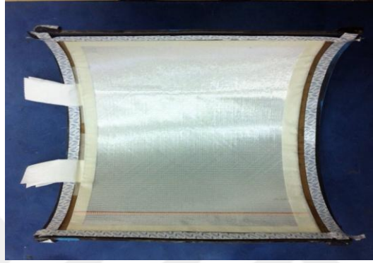
Şekil 3.15. Kumaşın kalıba yerleştirilmesi
