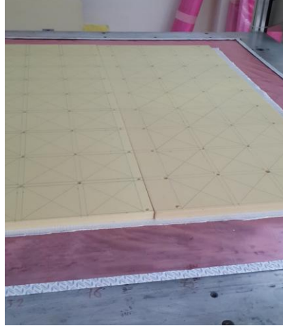
Şekil 3.22. Düz plakaların üretiminde köpük yerleşimi
