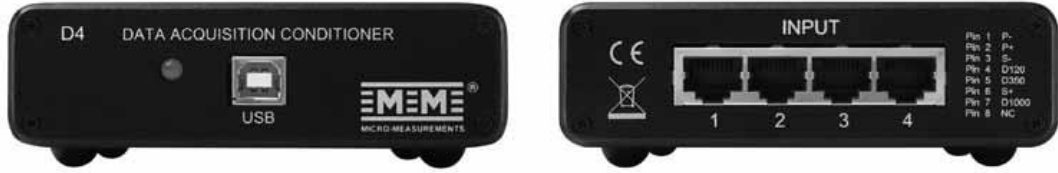
Şekil 71 : Data düzenleyici cihazında bulunan USB ve dört farklı giriş
