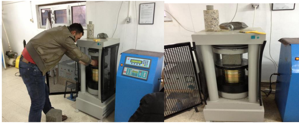
Resim 4.11. Basınç deneyi aşamaları
