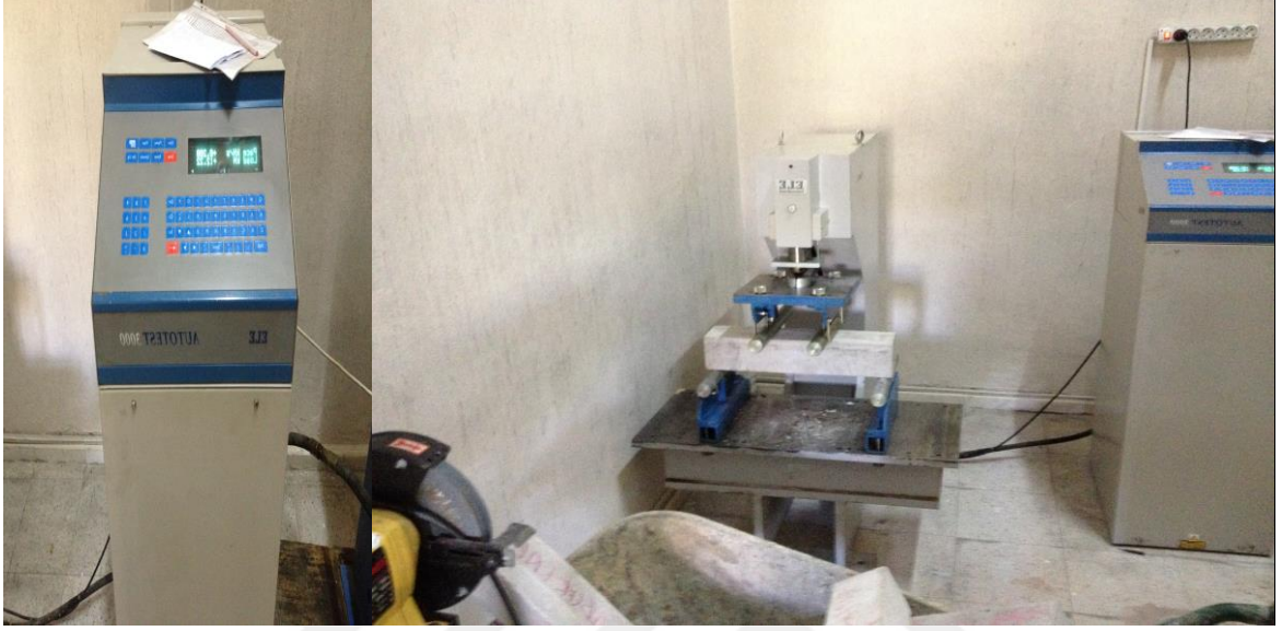
Resim 4.15. Numunelerin eğilmede çekme dayanımı deneyine tabi tutulması
