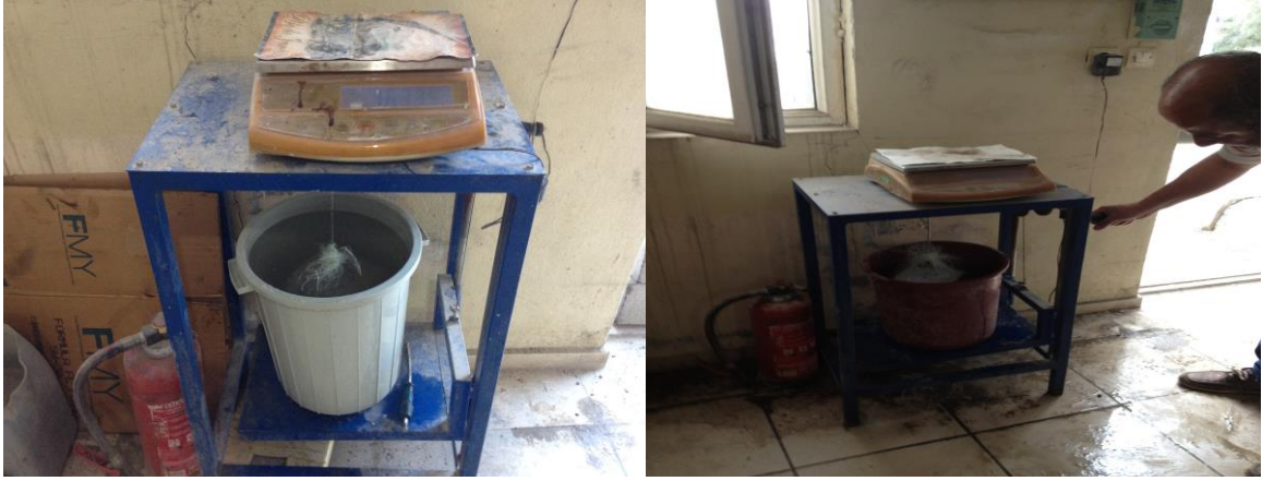
Resim 4.12. Porozite tayini deney düzeneği
