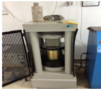
Resim 5.1. Küp numunenin basınç deneyine tabi tutulması
