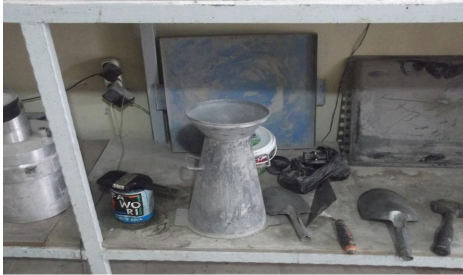
Resim 4.6. Slump (çökme) deneyinde kullanılan aletler
