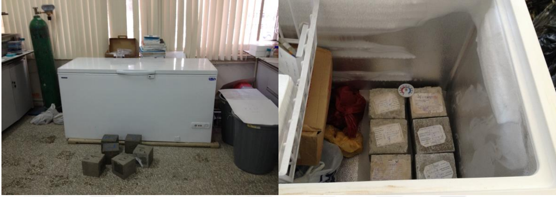
Resim 4.13. Numunelerin donma-çözülme çevrimi
