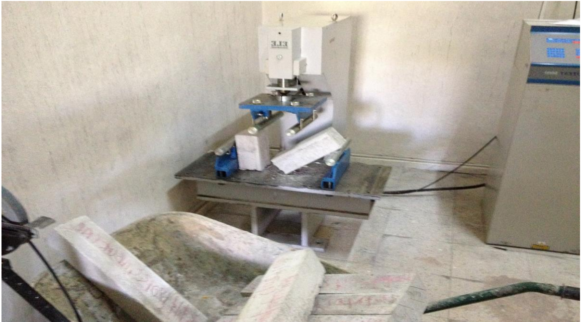
Resim 4.16. Numunelerin eğilmede çekme dayanımı deneyine tabi tutulması
