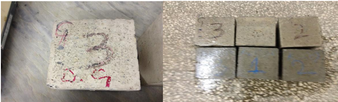
Resim 5.2. Donma-çözülme sonrası numuneler
