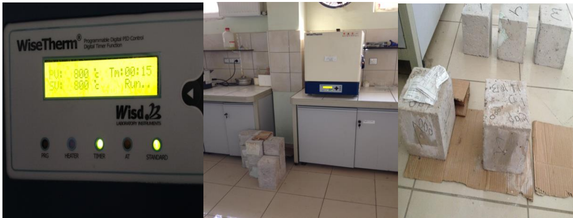
Resim 4.17. Numunelerin yüksek sıcaklık deneyine tabi tutulması
