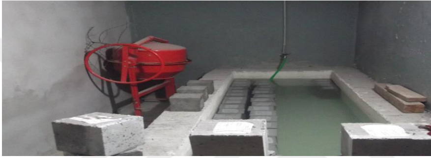
Resim 4.9. Kür havuzunda bekletilen numuneler
