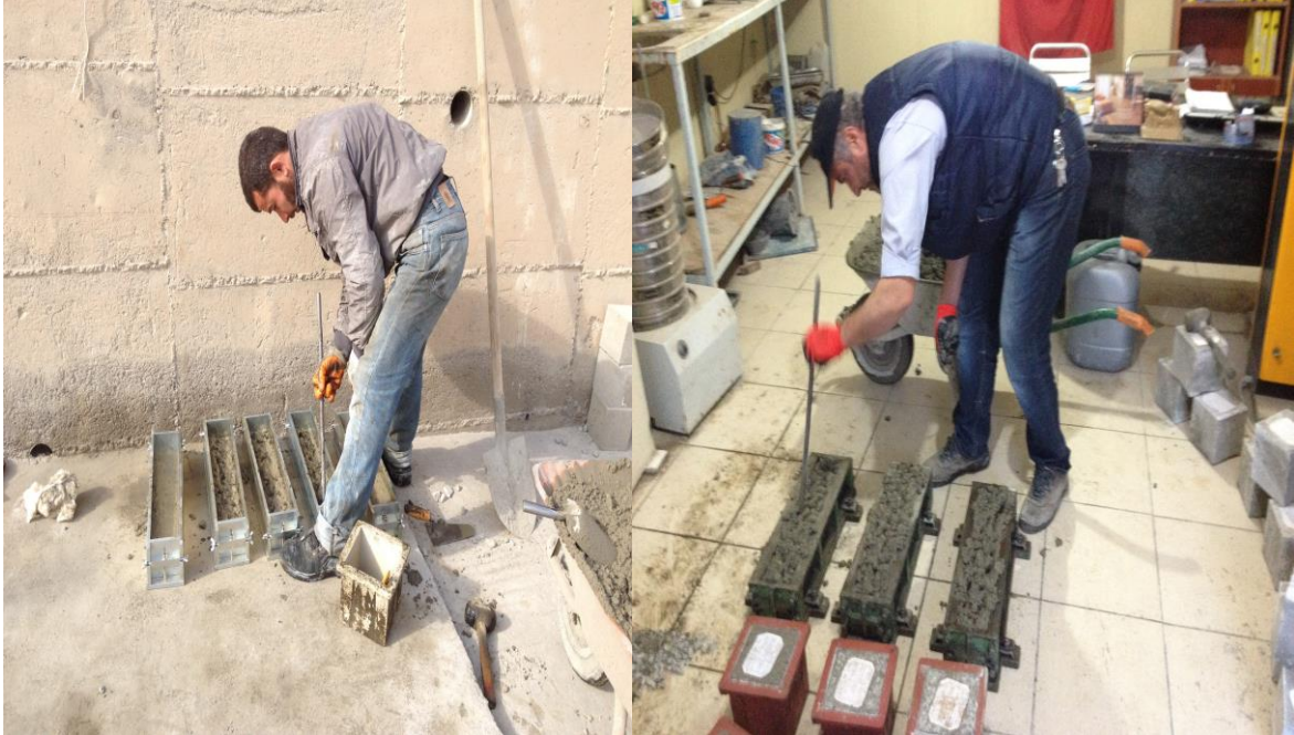
Resim 4.14. Eğilmede çekme dayanımı deneyi için numunelerin hazırlanması
