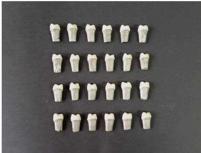
Şekil 3-66: Üst yapı seramiği pressleme yöntemi ile hazırlanan deney örnekleri
