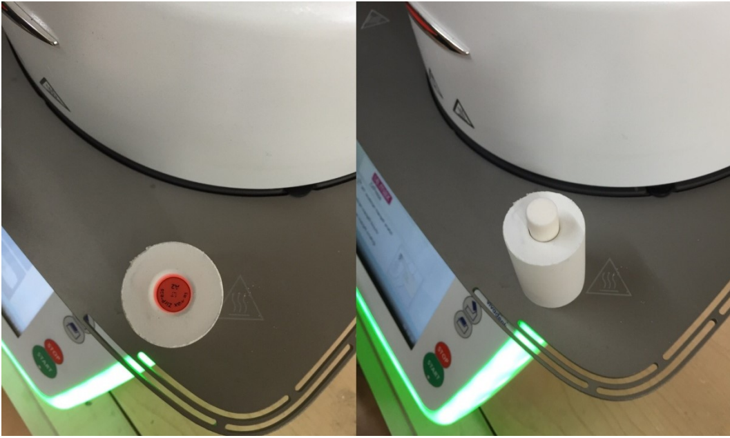
Şekil 3-59: Seramik ingot ve itici pistonun yerleştirilmesi
