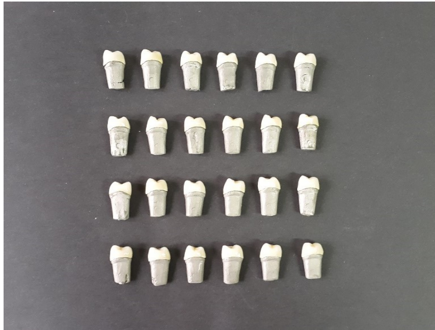
Şekil 3-52: Üst yapı seramiği tabakalama yöntemi ile hazırlanan deney örnekleri
