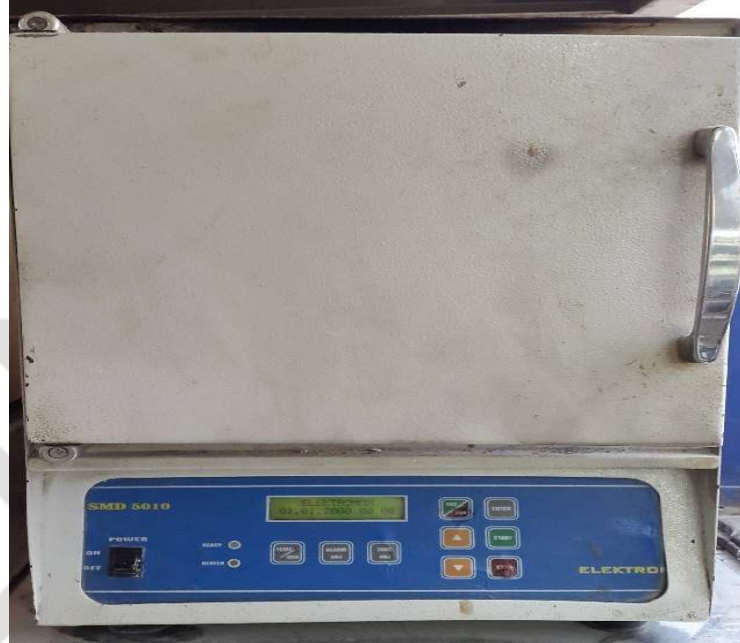
Şekil 3-13: Mum eliminasyon işlemi için kullanılan ön ısıtma fırını
