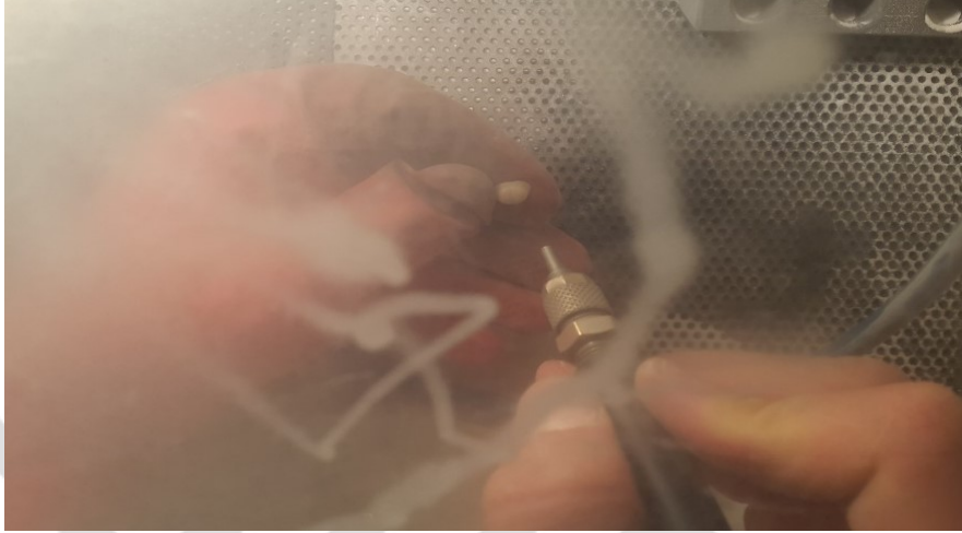
Şekil 3-80: Monolitik zirkonya kuron protezlerine uygulanan kumlama işleml
