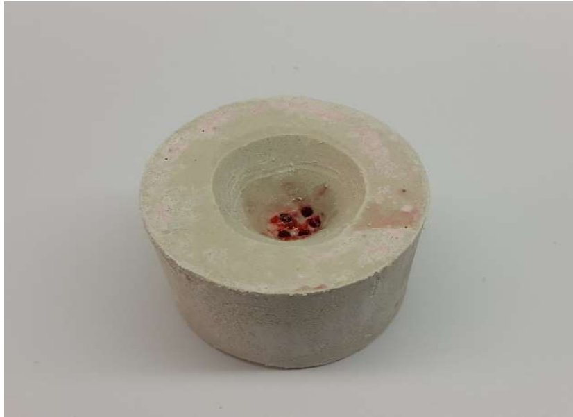
Şekil 3-12: Döküme hazır revetman kalıp
