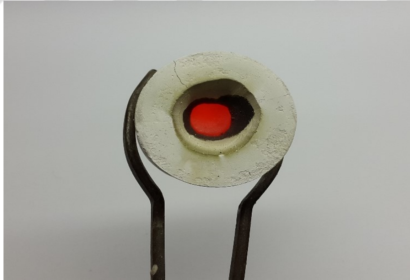
Şekil 3-17: Soğumaya bırakılan revetman kalıp
