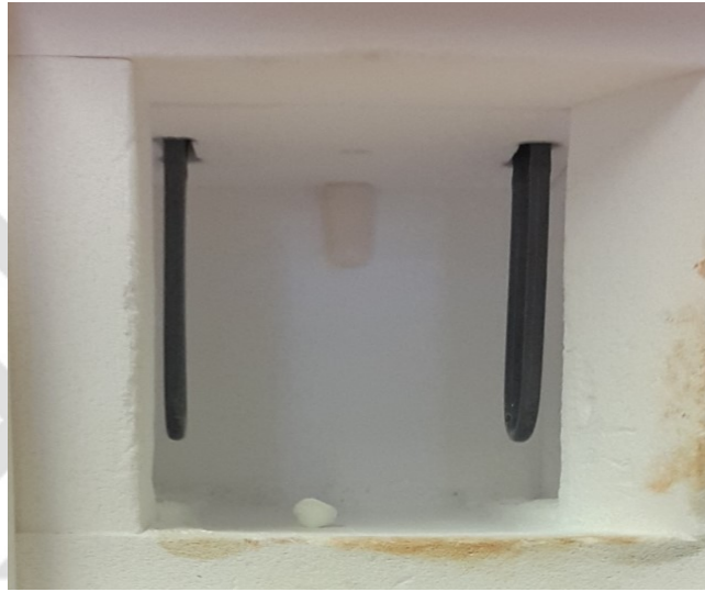
Şekil 3-78: Monolitik zirkonya kuron protezinin sinterleme işlemi
