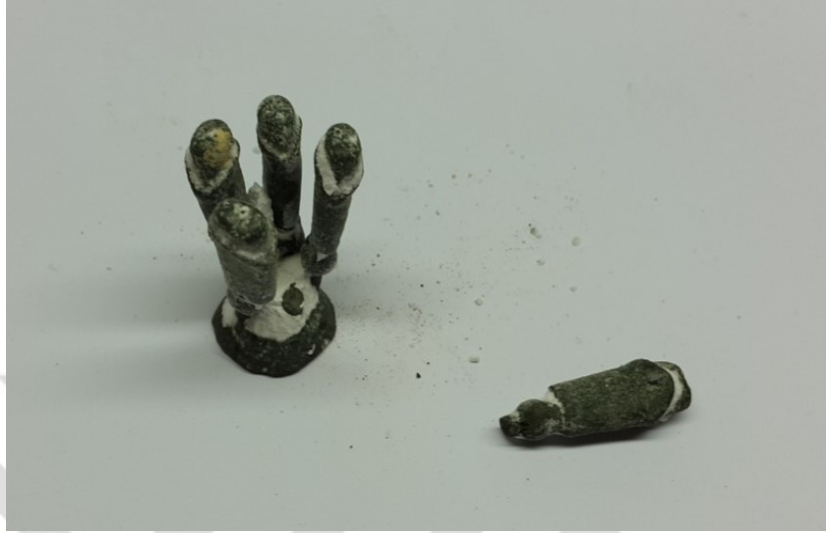
Şekil 3-18: Revetmanın kırılmasının ardından elde edilen metal dökümler
