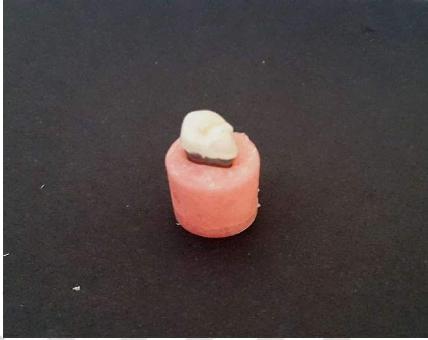
Şekil 3-101: Kırılma testi sonrası örneğin kırık görüntüsü
