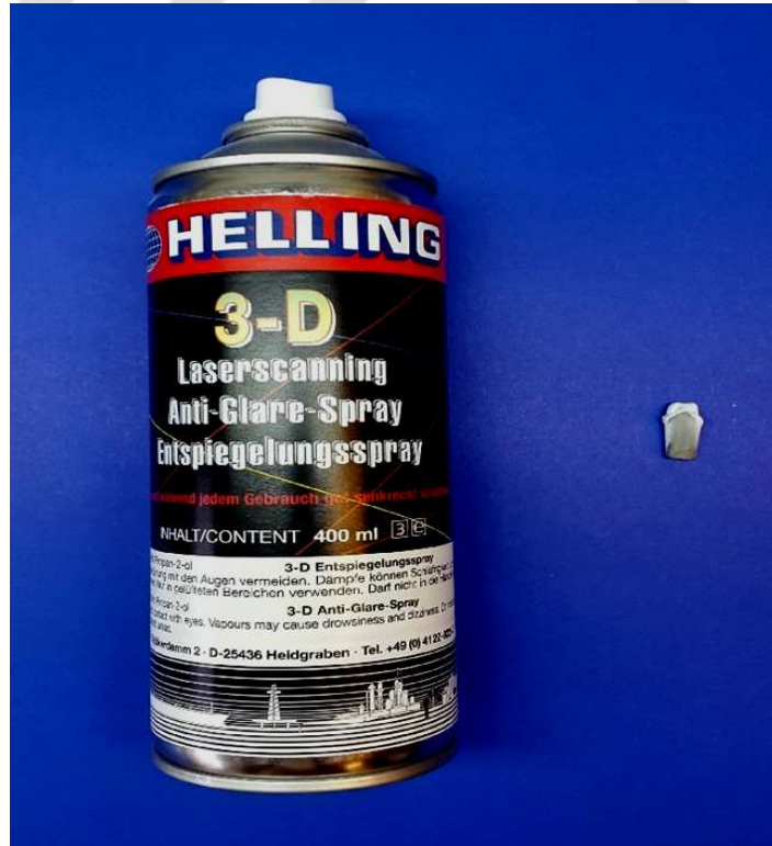
Şekil 3-24: Co – Cr metal diş modeline uygulanan parlama önleyici sprej
