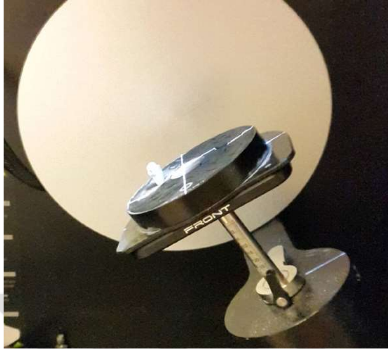
Şekil 3-27: Co – Cr metal diş modelinin farklı eksenlerde taramma işlemi
