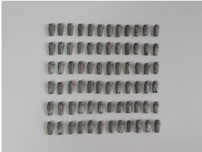
Şekil 3-21: Co - Cr metal alaşımından elde edilen dayanak diş modelleri
