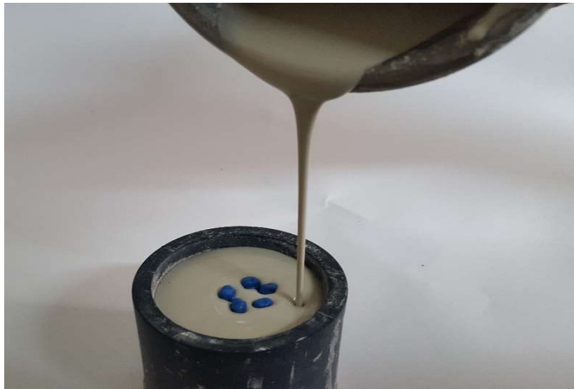
Şekil 3-10: Revetman karışımının manşete dökülmesi
