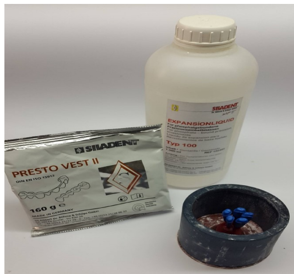
řekil 3-8: Kullanılan revetman tozu ve likiti
