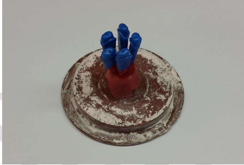
řekil 3-7: Mum modellerin manřete alınmak üzere hazırlanması
