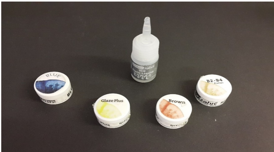
Şekil 3-81: Monolitik zirkonya için kullanılan glazür tozları ve likit
