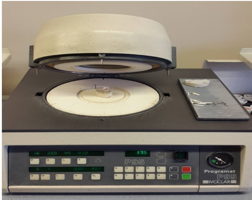
Şekil 3-45: Porselen fırınında üst yapı seramiğinin pişirilmesi
