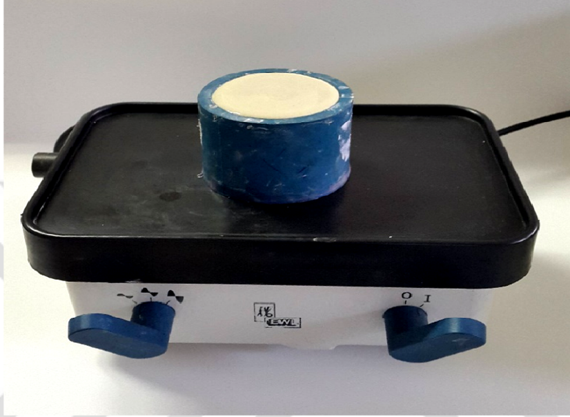
Şekil 3-11: Vibratör cihazında hava kabarcıklarının eliminasyonu
