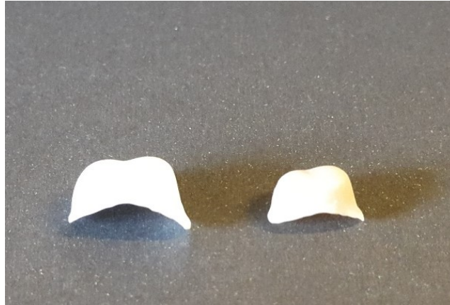
Şekil 3-40: Zirkonya alt yapının sinterleme öncesi ve sonrası görünümü
