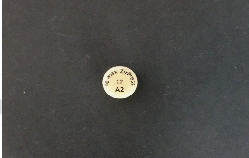
Şekil 3-53: Pressleme tekniği için kullanılan seramik ingot
