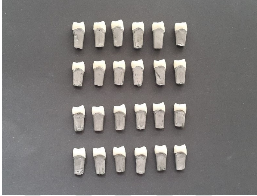
Şekil 3-84: Hazırlanan monolitik zirkonya deney örnekleri
