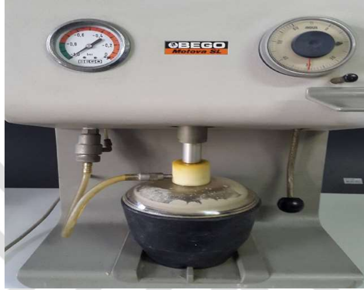
Şekil 3-9: Vakumlu cihazda revetmanın karıştırılması
