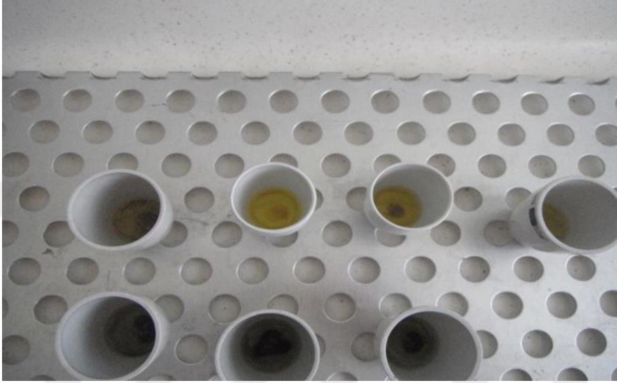
Şekil 3.6. Besin elementi analizi için yapılan kuru yakma işlemi.
