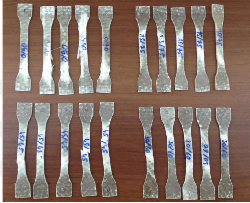
Şekil 7.14: Çekme testine tabi tutulmuş farklı fiber oryantasyon açısındaki numuneler.
