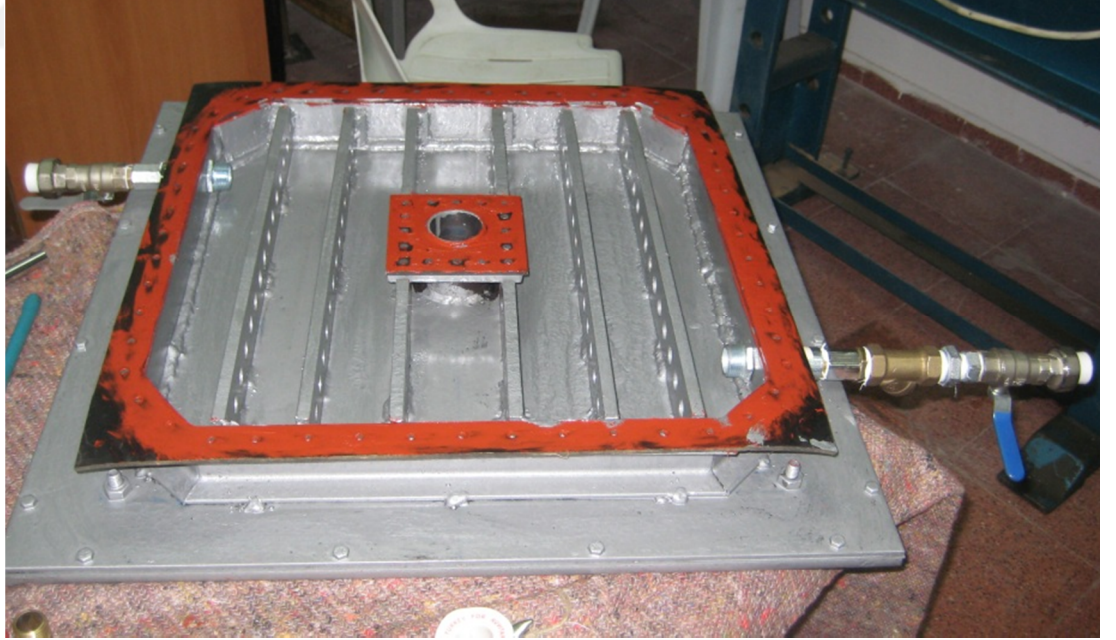
Şekil 4.5: Kalıbın ısıtılması için tasarlanan sıcak su kanalları.
