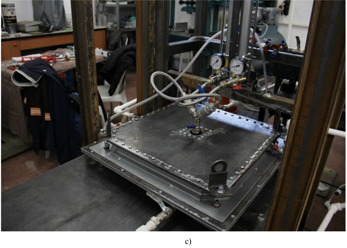
Şekil 4.3: Alt ve üst kalıp, a) Alt kalıp, b) Üst kalıp, c)Montajlanmış kalıp.
