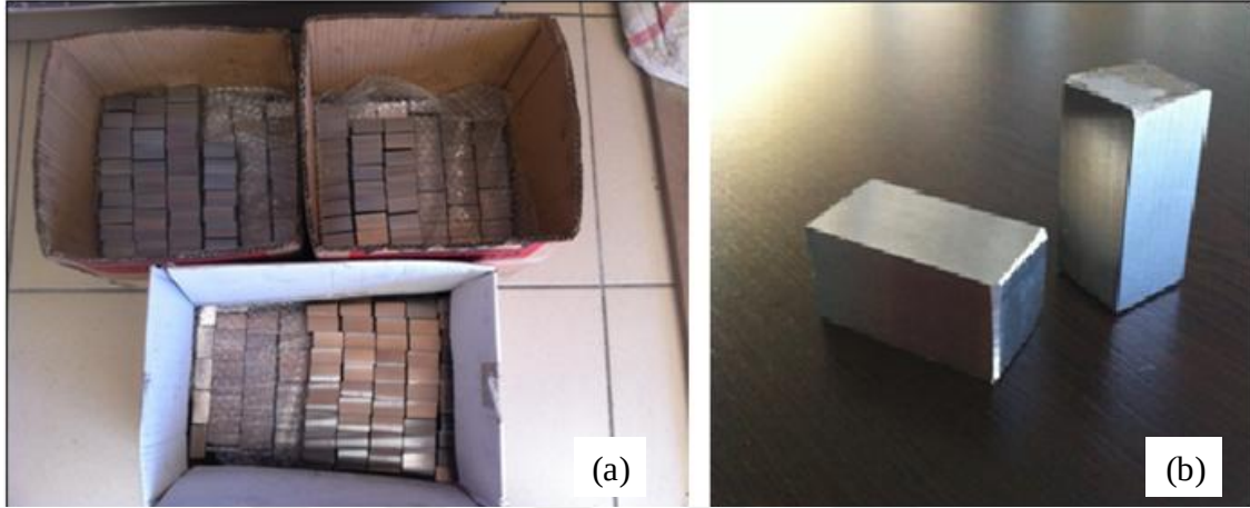
Şekil 4.9. AISI4140 işparçaları: a) kesilmiş işparçaları, b) taşlanmış işparçaları
