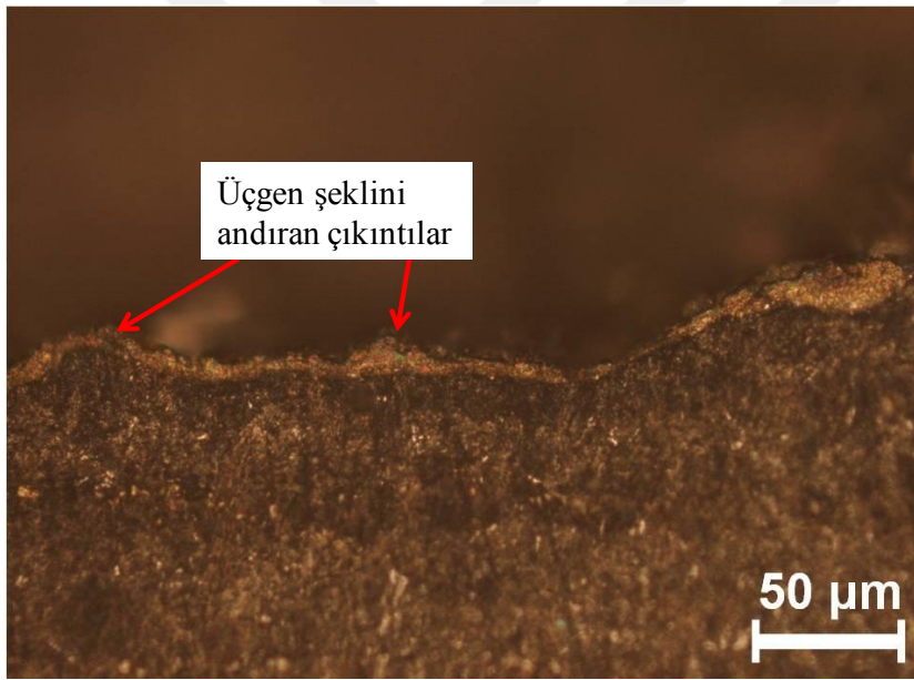
Şekil 6.5. AISI4140 çeliğinin işlenmiş yüzeyinde görülen ve üçgeni andıran çıkıntılar
