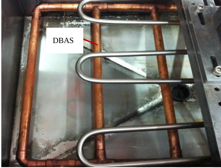
Şekil 4.5. Tank içerisindeki delikli boru ağı sistemi (DBAS)
