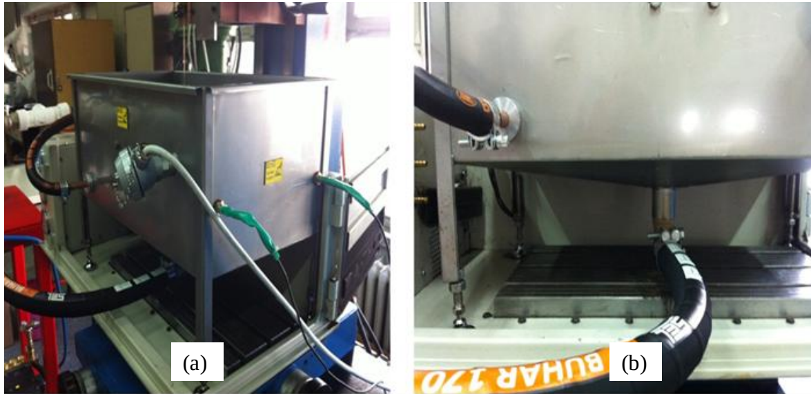
Şekil 4.4. Dielektrik tankı: a) tank gövdesi, b) tank ayakları ve konik tabanı
