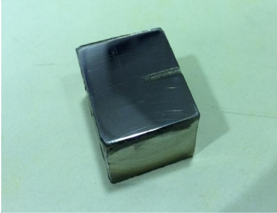
řekil 8.8. Kör delik delinip daęlanmıř ve parlatılmıř AISI4140 elięi iřparası
