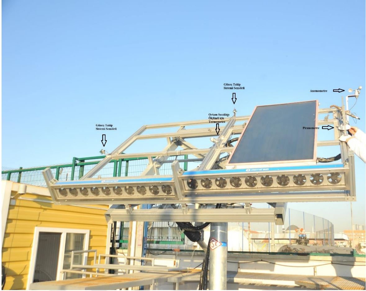
Resim 5.6. Kolektörün deney düzeneğine bağlanması
