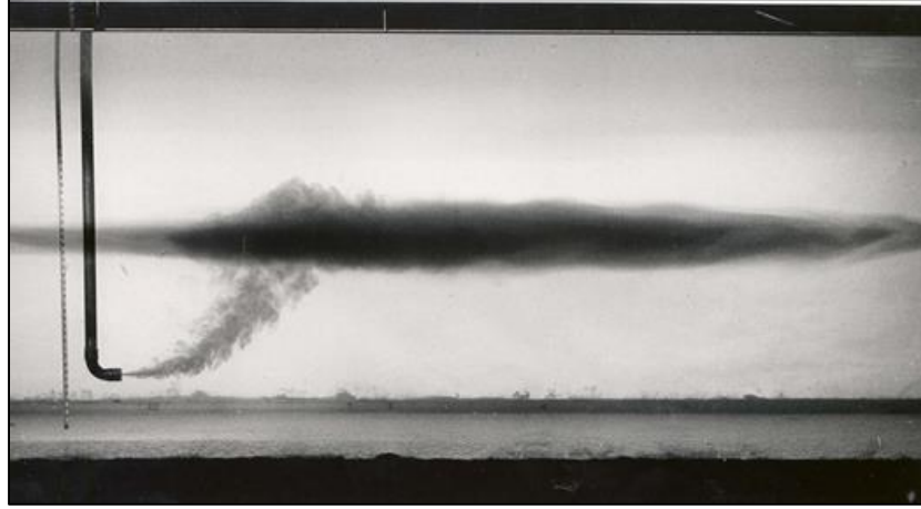
Şekil 3.2: Sıcak su deşarjı için hazırlanmış genel atıksu jeti deşarj karakteristikleri.
