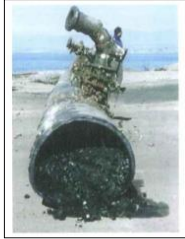
Şekil 2.27: Kağıt endüstrisi atıksularının yayıcıyı tıkaması (Butler ve diğ., 2003).
