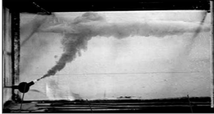
Şekil 2.36: Yoğunluk Stratifikasyonu ile Yüzey Altında Oluşmuş Seyrelme Bulutu [ Laboratuvar ortamında hazırlanmış yoğunluk katmanlı alıcı ortam içerisinde kirlilik bulutunun tutsaklanması (Bleninger ve Jirka, 2005) ]
