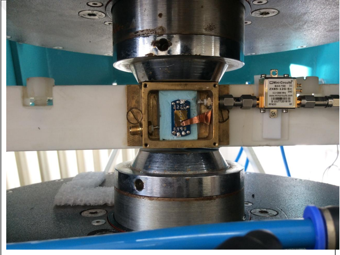
Şekil 5.16: Si/SiO 2 (200nm)/IrMn(20nm)/Co(6nm)/Cu(3nm)/Py(6nm)/Pt(3nm) örneđinin RF ekranlama kutusu içindeki görüntüsü.
