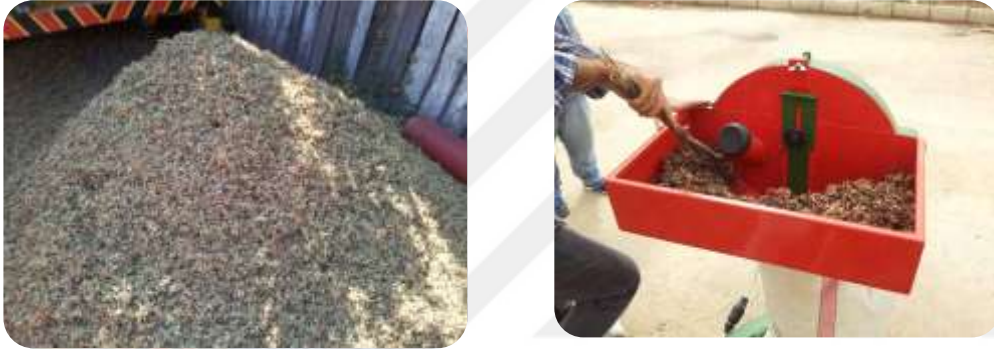
Şekil 3.6. Tarımsal artıkların öğütülmesi
