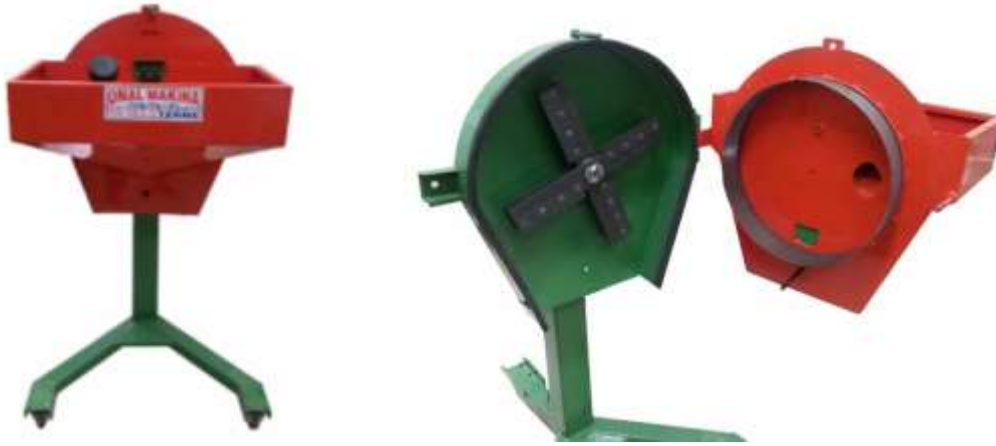
Şekil 3.5. Zurufların farklı incelikte öğütülmesinde kullanılan çekiçli değirmen
