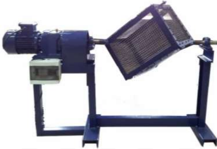
Şekil 3.10. Düşme-dayanıklılık test düzeneği
