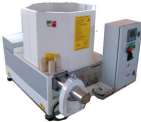
Şekil 1.10. Hidrolik pistonlu briketleme makinesi (KTAE, 2015)
