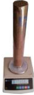
Şekil 3.16. Materyal hacim ağırlığının belirlenmesi
