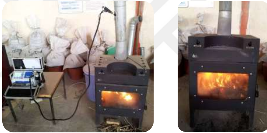
Şekil 3.18. Baca gazı ölçüm cihazı probunun yerleştirilmesi
