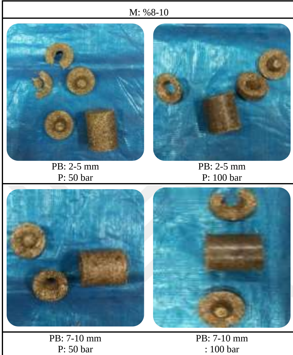
Şekil 4.9. AS briketlerinin kırılma direnci testi sonrası görünümleri (M:%8-10)
