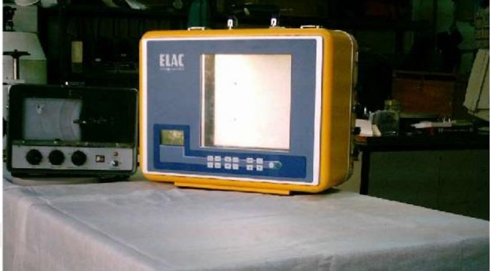
Şekil 2.3: Derinlik ölçer-EchoSounder (Erbaş vd., 2004).
