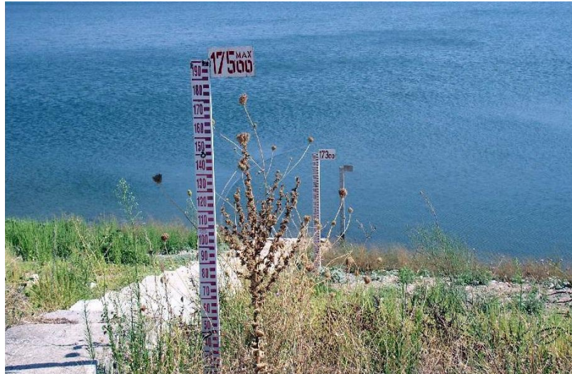
Şekil 2.7: Su kotu belli olan nivelman noktaları (URL-2).
