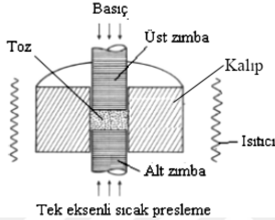
Şekil 1.11. Tek eksenli sıcak presleme işleminin kesit olarak gösterilişi (German, 2007).
