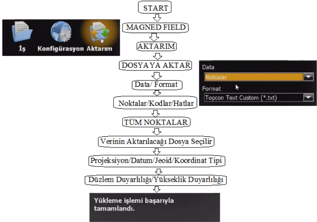
Şekil 4.13CORS cihazı dosya aktarma
