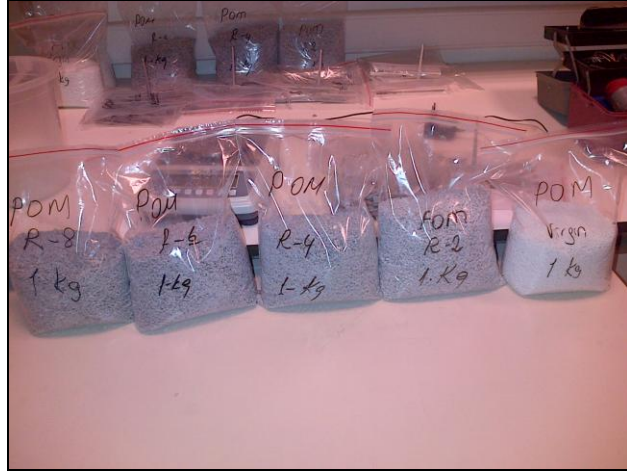
Şekil 4.19: Karışımlarda kullanılan geri dönüşüm numuneleri.
