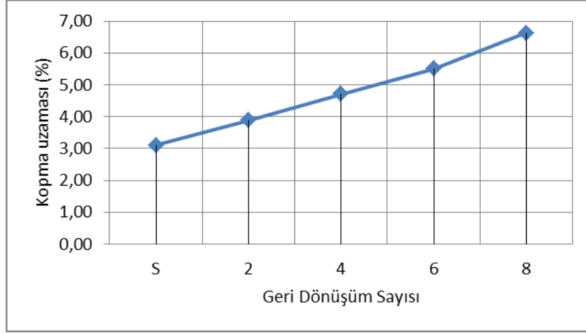
Şekil 6.8: POM geri dönüşüm sayısına bağlı kopma uzaması grafiği.
