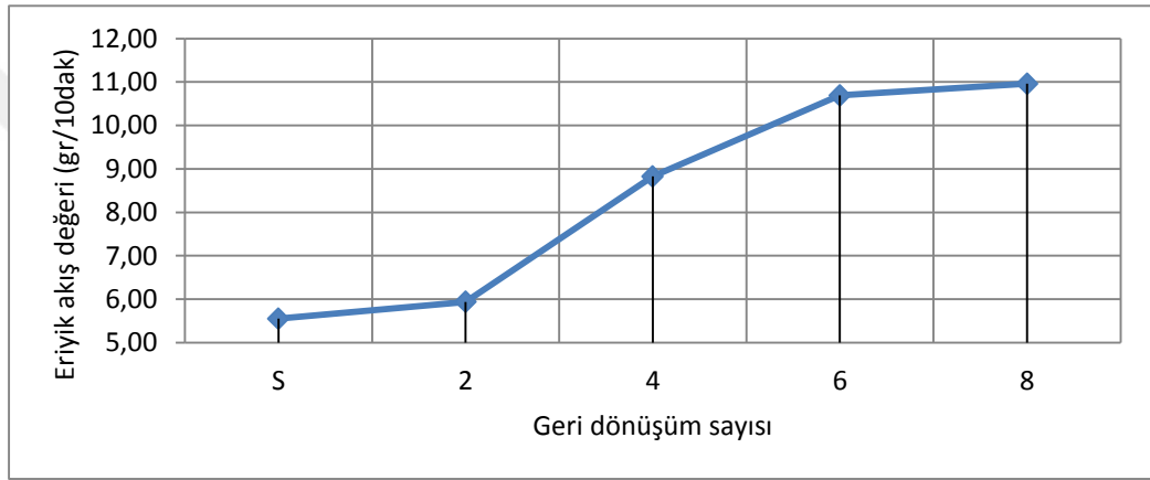
Şekil 6.1: POM malzemesi geri dönüşüm sayısına göre eriyik akış grafiği.
