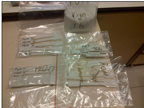
Şekil 4.18: Gruplanmış test, deney ve geri dönüşüm numuneleri
