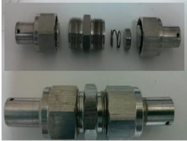
Şekil 2.11. Swagelok tipi iki elektrotlu hücre düzeneği
