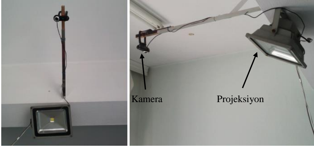
Şekil 8.5. Uygulamada kullanılan 50W gücünde tepe aydınlatması
