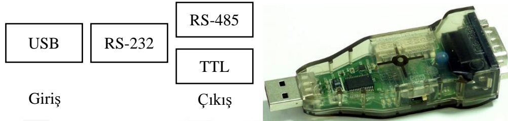
Şekil 7.12. USB2Dynamixel yapısı ve aparat şekli
