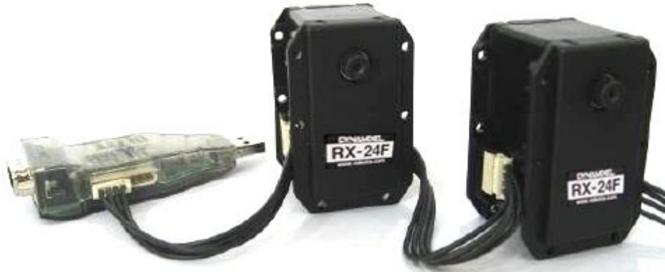
Şekil 7.8. USB2Dynamixel aparatı ve motor bağlantı şekli
