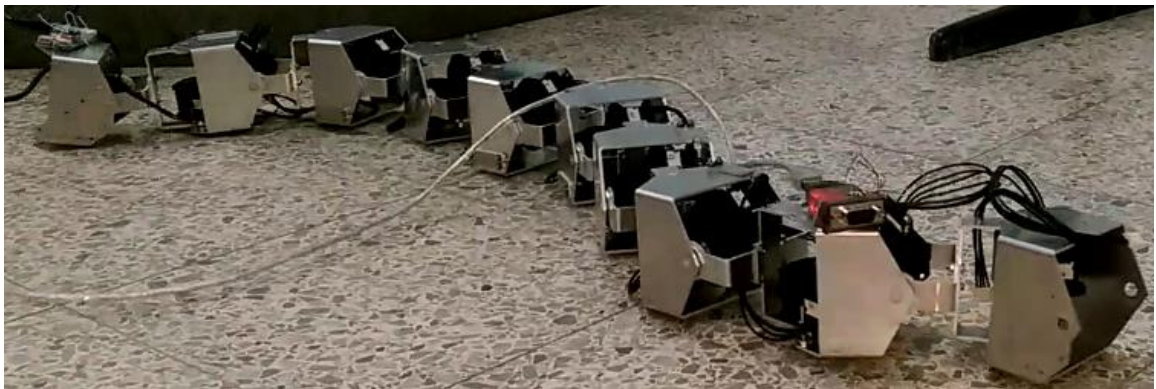
Şekil 7.2. İlk tasarlanan robot kasası montajlı hali ve deneme çalışması
