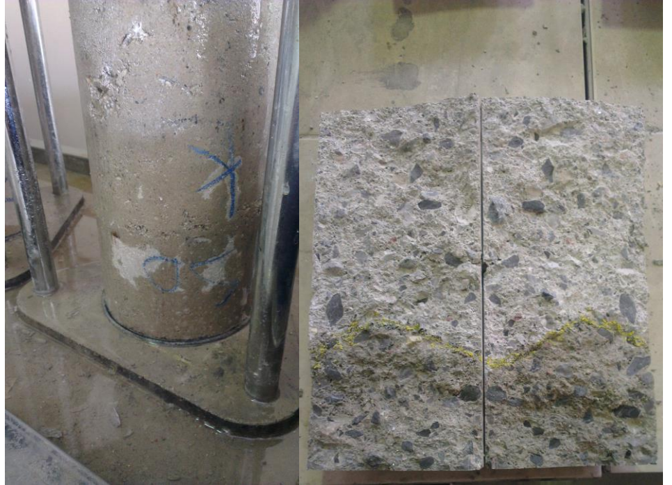
Şekil 3.25: Basınçlı su altında su işleme derinliğine ait fotoğraflar. (Soldaki fotoğraf 150 kg dozajlı karışımda suyun diğer yüze ulaşmadan dışarıya sızdığını gösteren resim. Sağdaki fotoğraf ise 250 dozlu bir örnekte basınçlı suyun nüfuz ettiği bölgeyi gösteren resim.)
