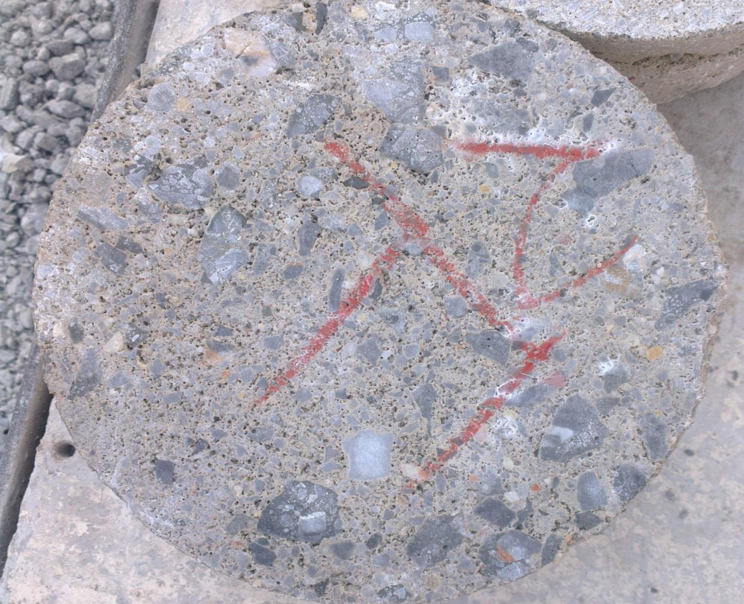
Şekil 4.32: Donma çözülme deneyine ait fotoğraf. (Fotoğraf 250 dozajlı karışıma aittir ve numune içindeki boşlukları göstermektedir.)
