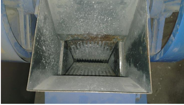
Şekil 3.2: Beton atıklarının agrega haline getirildiği kırıcının hazne görüntüsü
