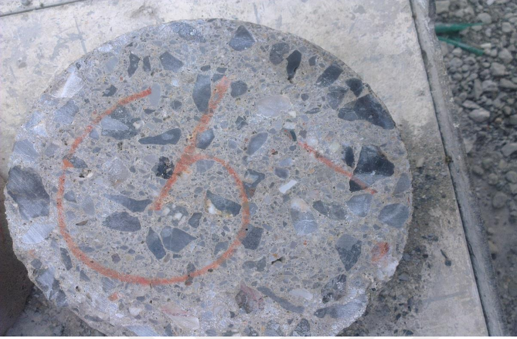
Şekil 4.31: Donma çözülme deneyine ait fotoğraf. (Fotoğraf 250 dozajlı karışıma aittir ve numune içindeki boşlukları göstermektedir.)
