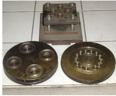
Şekil 5.15. Kalıcı deformasyon numune pişirme düzeneği
