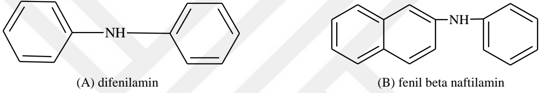
Şekil 1.15. (A) difenilamin ve (B) fenil beta naftilamin genel yapısı [8]
