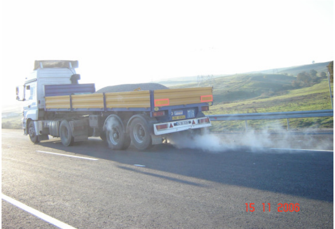
Şekil 3.2. Frenleme sonucu ısınan balataların soğutulması
