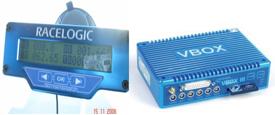
Şekil 3.7. Testlerde kullanılan veri toplama sistemi (Racelogic-Vbox)
