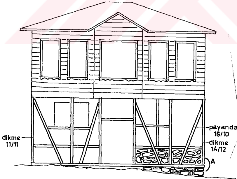
b. Değirmendere, taşıyıcı dikmelerin bir taban aracılığı ile temele oturtulduğu yapılara örnek
