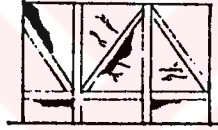
Kısmi dolgu dökülmesi
