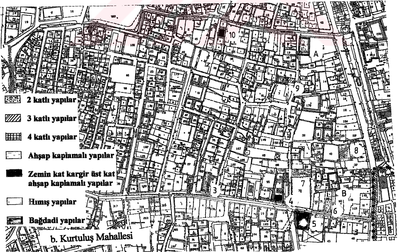
Şekil E.33 Adapazarı'nda deprem öncesinde mevcut geleneksel ahşap iskeletli yapıların kat adetleri ve yapıım teknikleri
