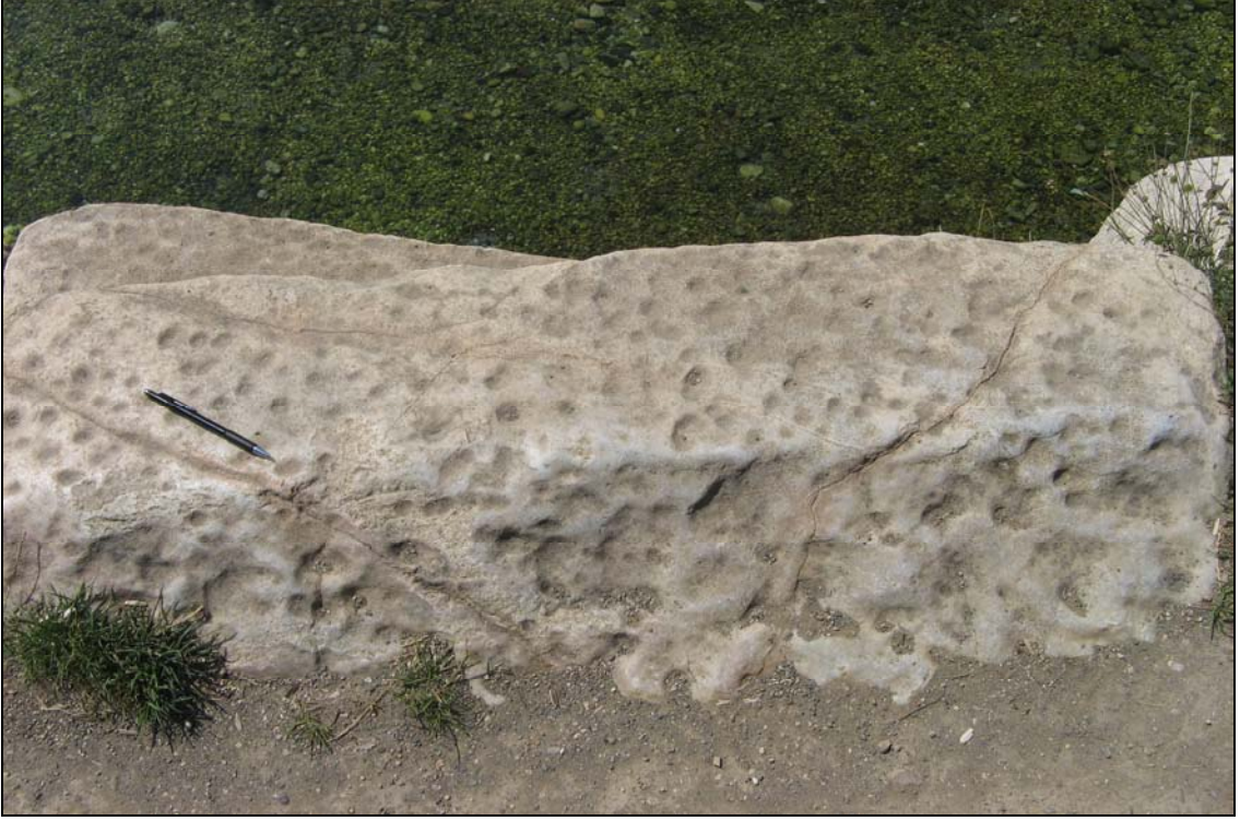
Fotoğraf 3.6 Mermerlerde gözlenen süreksizlikler ve kayaçta gözlenen yersel erimeler
