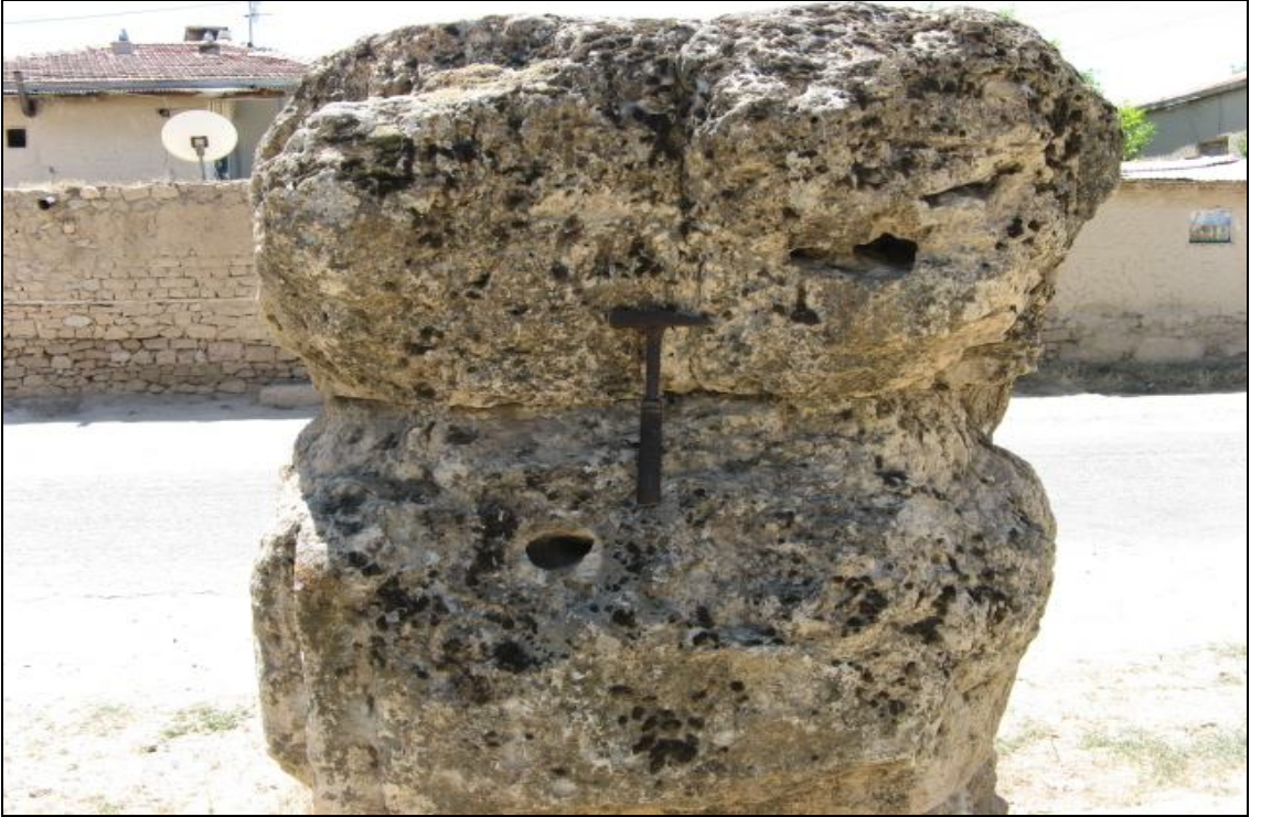
Fotoğraf 3.14 Farklı boşluk yapısına ve dokuya sahip travertenlerden görünüm
