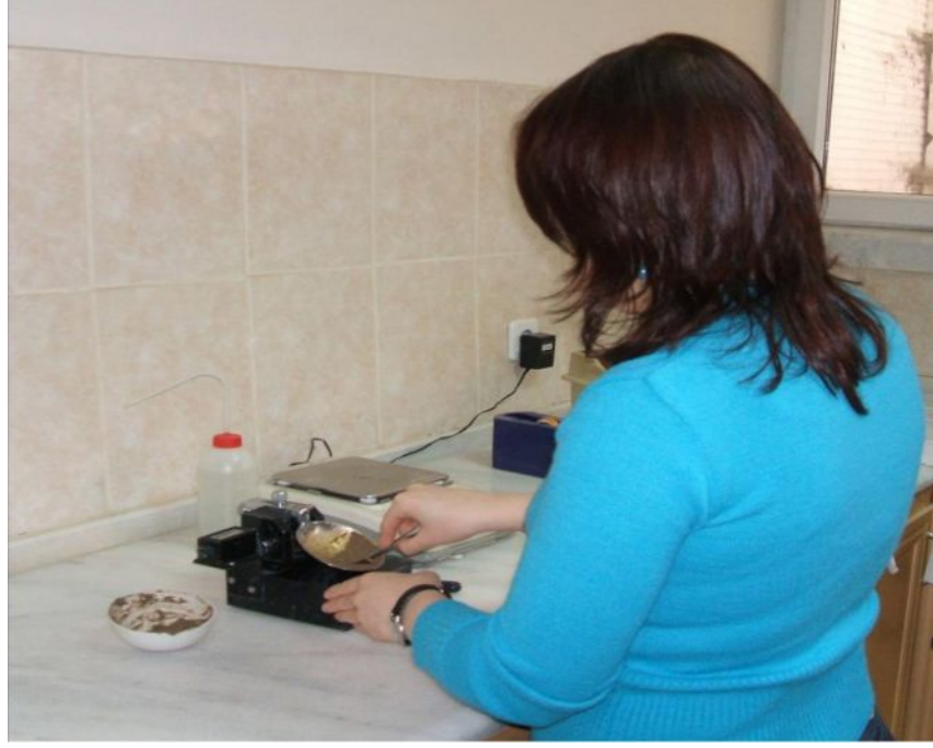
Foto 4.3 Casagrande aletinde likit limitin belirlenmesi
