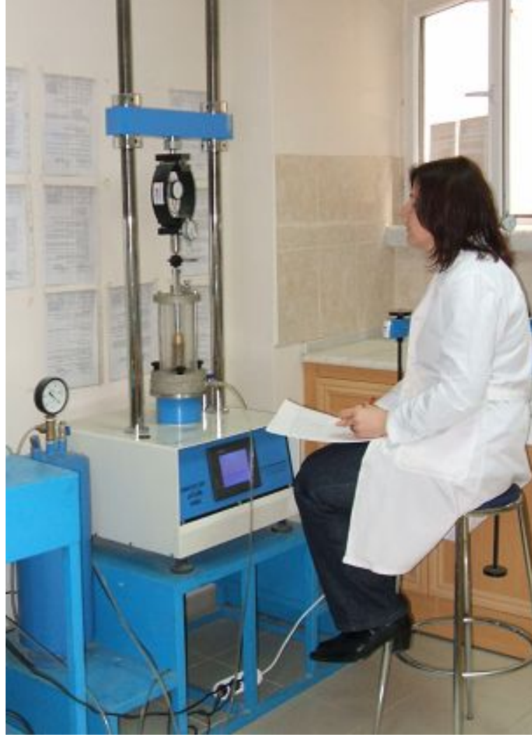
Foto 4.4 Üç eksenli basınç deneyinin yapılışı
