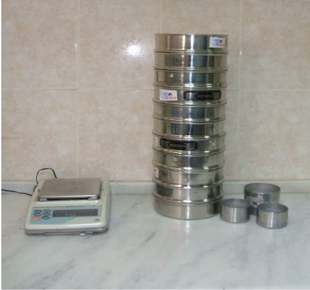
Foto 4.2 Elek analizi için kullanılan eleklerin dizilişi
