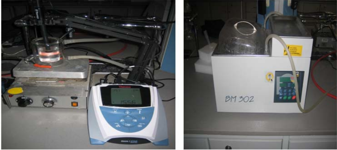
Şekil-3.1. : Doku homojenatı temelli biyosensörler ile ölçüm alınırken deney düzeneğinin ve kullanılan sürkölasyonlu su banyosunun resmi
