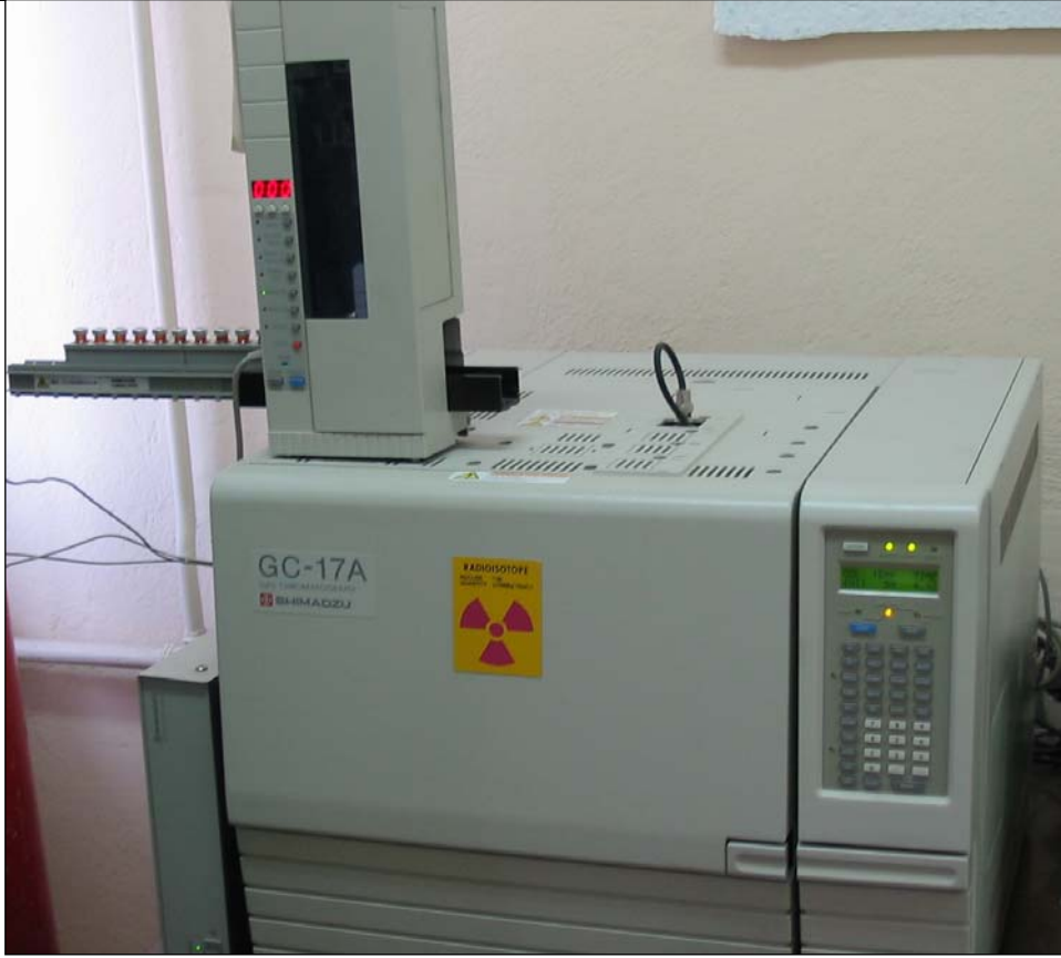
Shimadzu GC 17 A Gaz Kromatograf, FID dedectör ile donatılmış,
