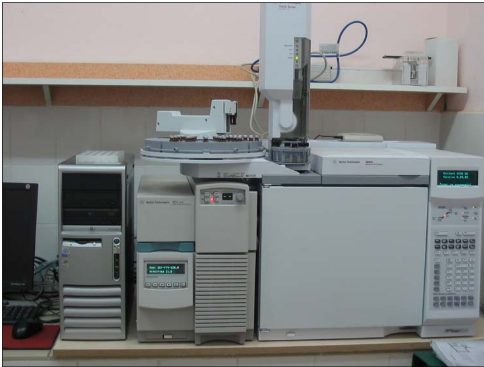
7663 B Autosampler ile donatılmış, 5973 seri MS dedektörle donatılmış Agilent 6890 N gaz kromatografisi
