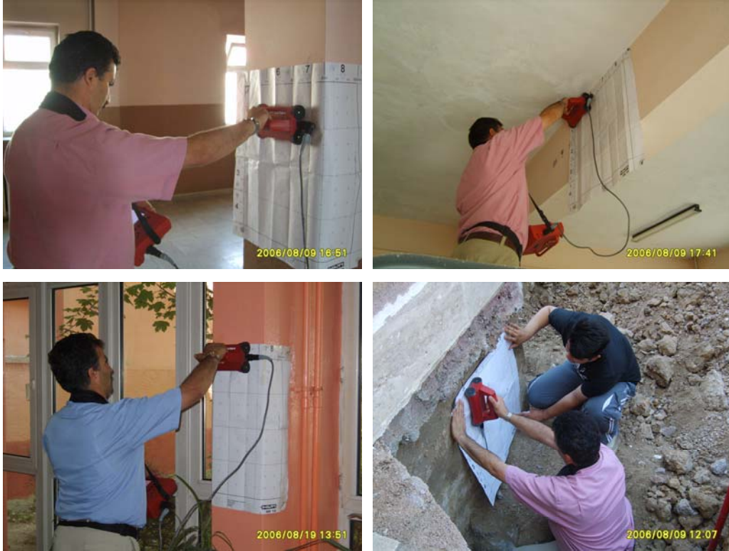
Şekil 3.17 Donatı tespit cihazı ile çalışma görüntüleri
