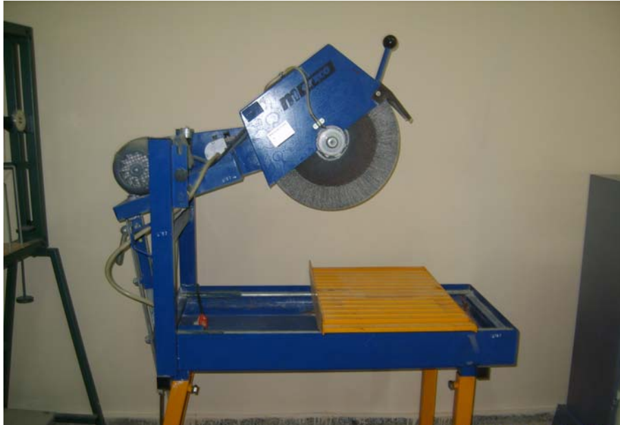
Şekil 3.13 Karot kesmek için kullanılan alet
