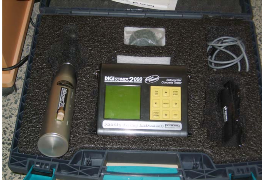
Şekil 3.8 Dijital beton test çekici
