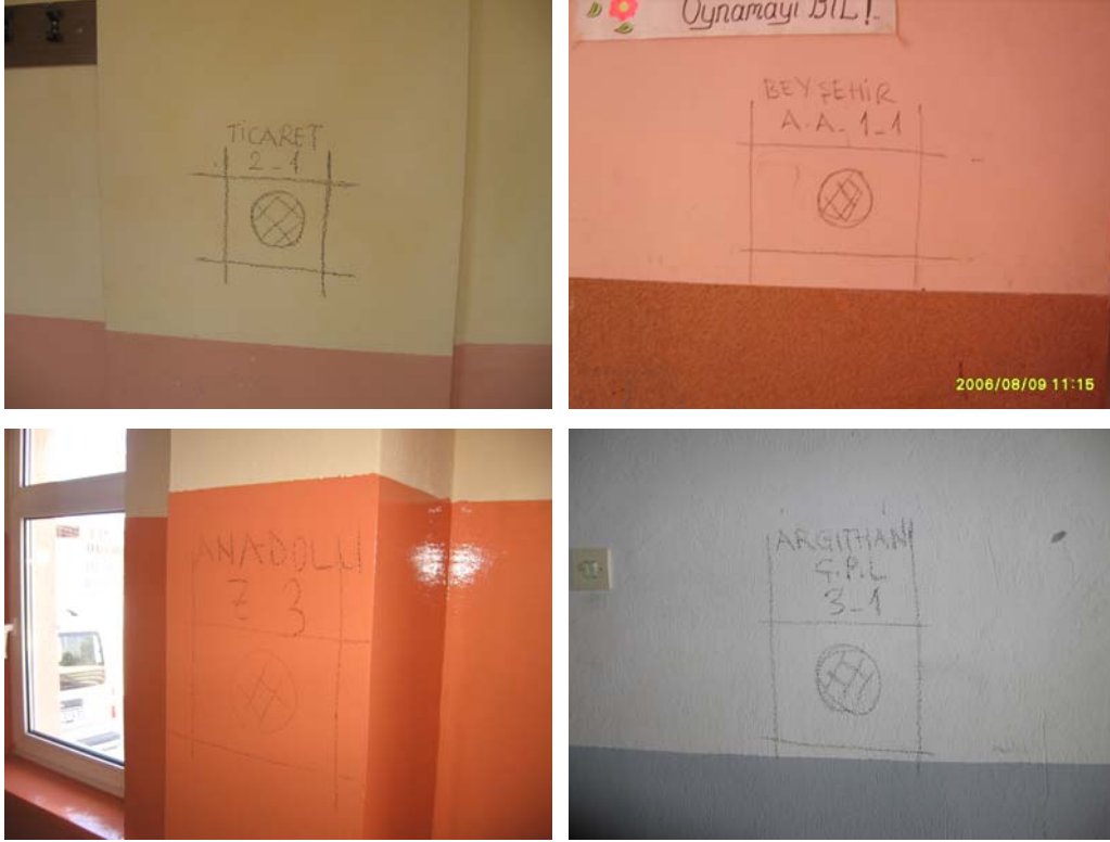
Şekil 3.10 Karot alımı öncesi donatı yerlerinin tespit edilme ve isimlerinin verilmesi görüntüleri
