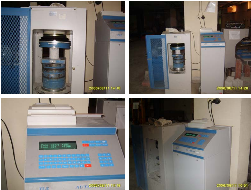
Şekil 3.15 Beton basınç deneylerinin gerçekleştirildiği pres ve deneylerin gerçekleştirilme görüntüleri
