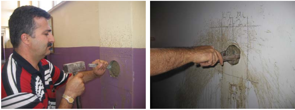
Şekil 3.12 Karot numunesini yerinden çıkartma işlemi
